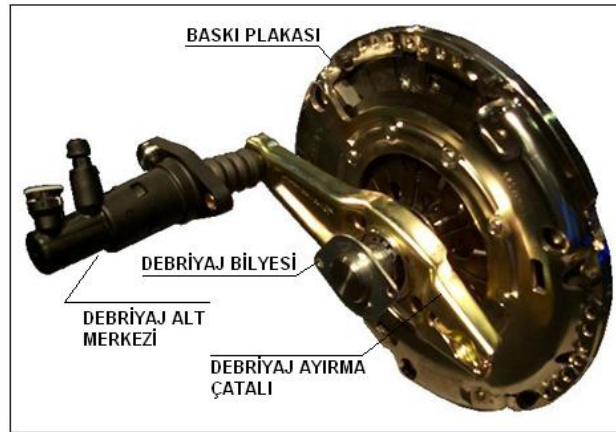
Resim 3.1: Debriyaj ayırma silindiri ile ayırma çatalının konumu
