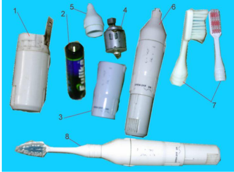
Şekil 5.1: Diř fırçasının parçaları
