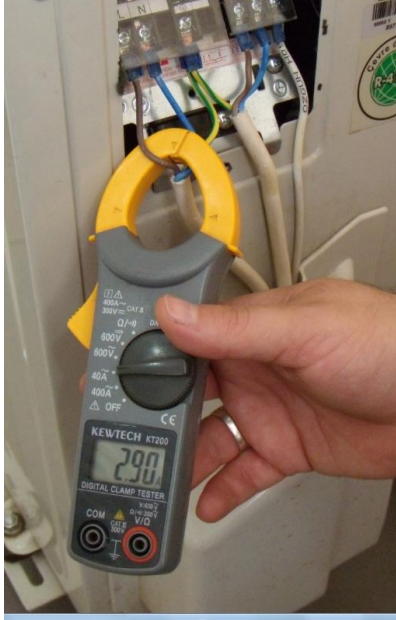
Resim.2.37: Pens ampermetre ile akım ölçülmesi
