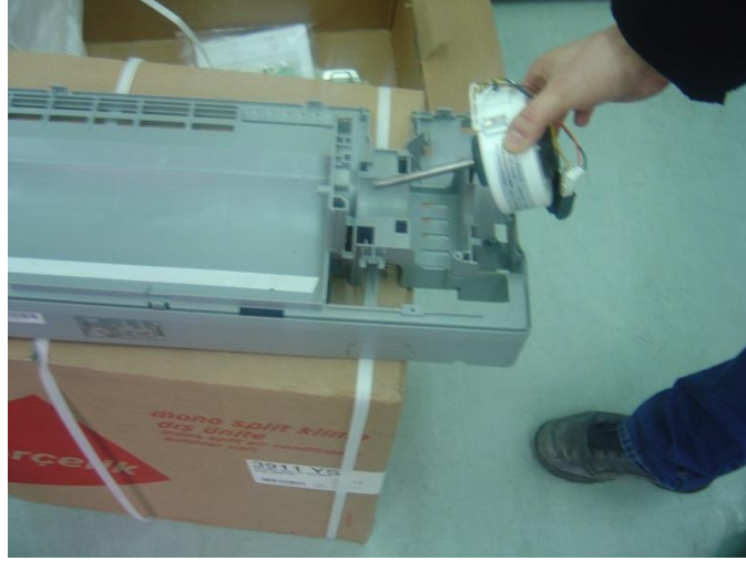
Resim.2.8: Fan motorunun yerinden sökülmesi
