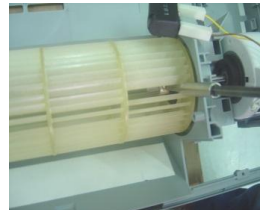
Resim.2.6: Fan kanatların yerinden sökülmesi
