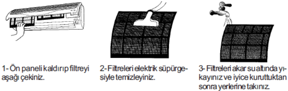
Şekil.2.1.Hava filtresinin temizleme işlem sırası
