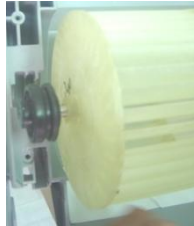
Resim.2.6: Fan kanatların yerinden sökülmesi
