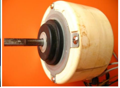
Resim.2.34: İç ünite fan motorunun sökülüp yağlanması
