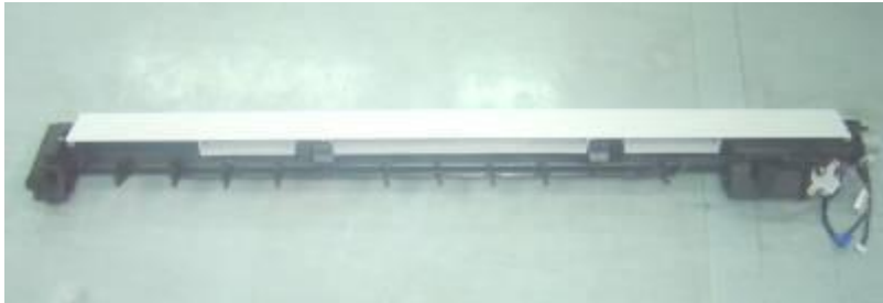
Resim.2.3:Hava yönlendirme kanalın sökülmesi
