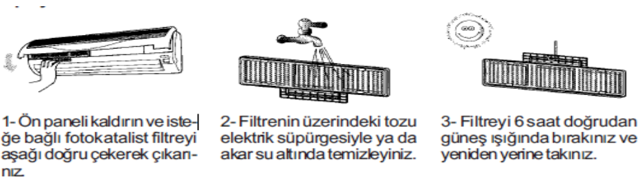
Resim.2.22: Plazma filtresinin çıkarılması
