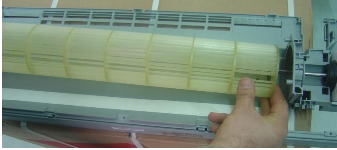
Resim.2.7.Fan motorunun yerinden sökülmesi
