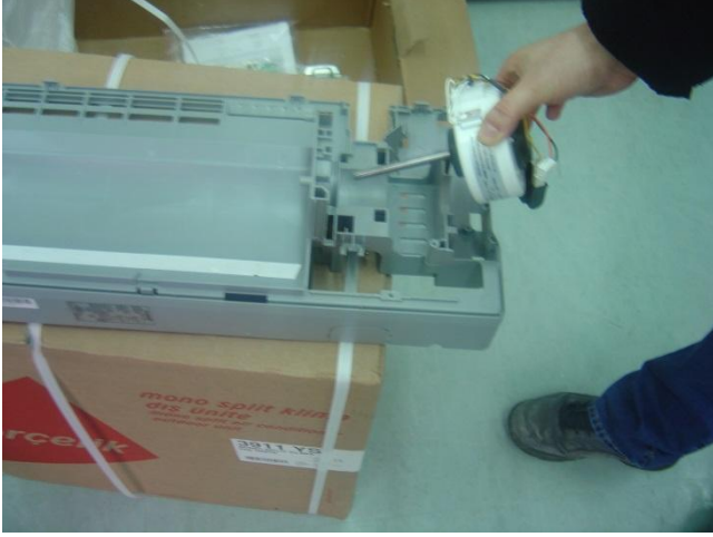
Resim.2.34: İç ünite fan motorunun sökülüp yağlanması
