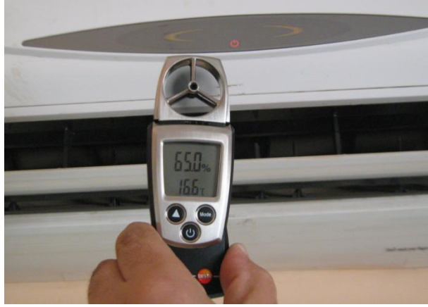
Resim.1.6: Anemometre ile fan devir testi
