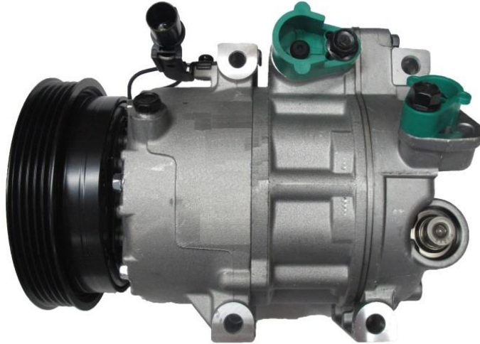
Resim 1.8: Açık tip kompresör
