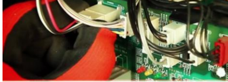
Resim 2.13: Motor uçlarının sökülmesi
