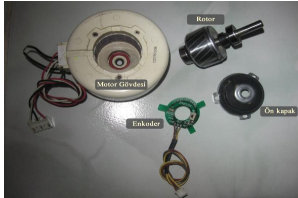
Resim 2.11: İç ünite fan motorunun sökülmüş hâli
