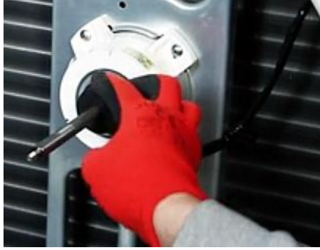
Resim 2.15: Motor milinin dönüş kontrolü
