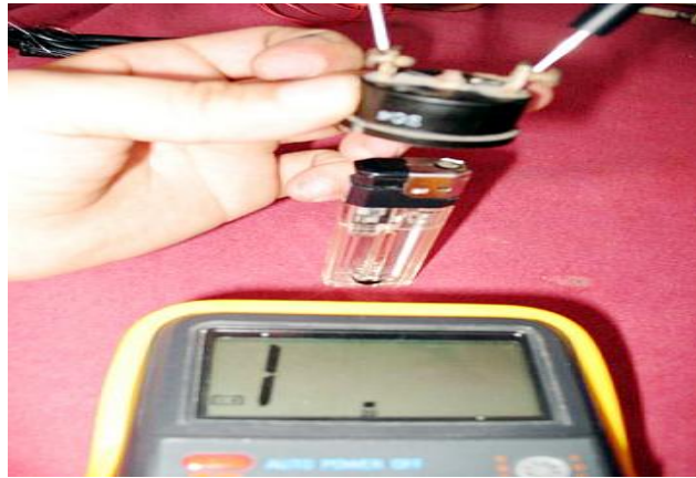
Resim 2.18: Termik bi-metalinin ısıtılması ve kontaklarının kontrolü
