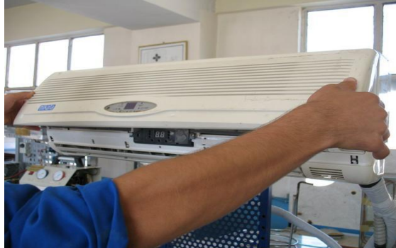
Resim 2.5: Klima ön panelinin sökülmesi işlemi
