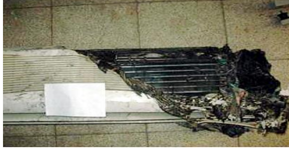
Resim 2.27: Trafodan kaynaklı elektronik kartın yanması
