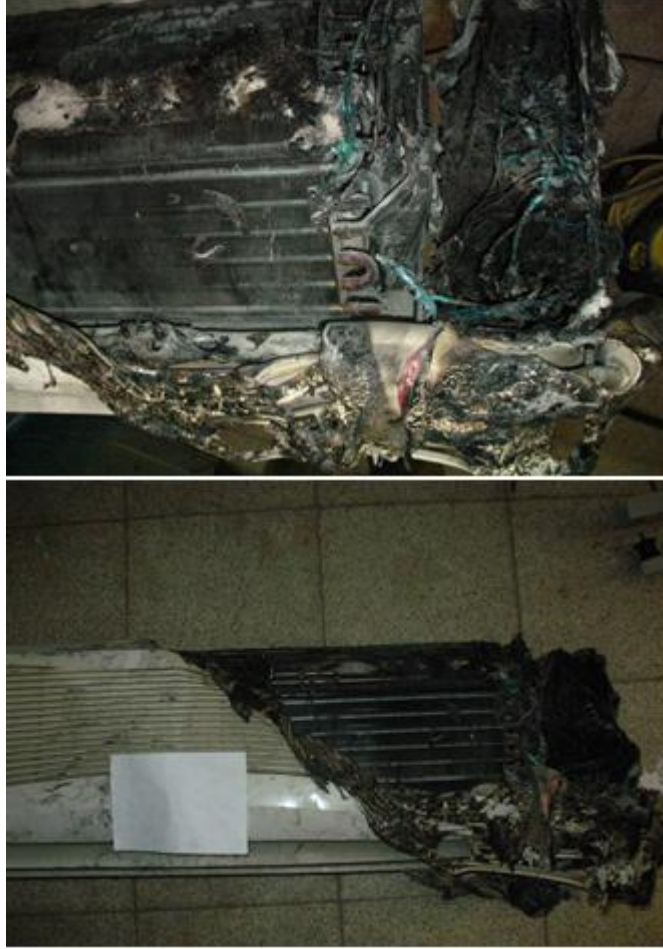
Resim 1.11: Trafodan kaynaklı elektronik kartın yanması
