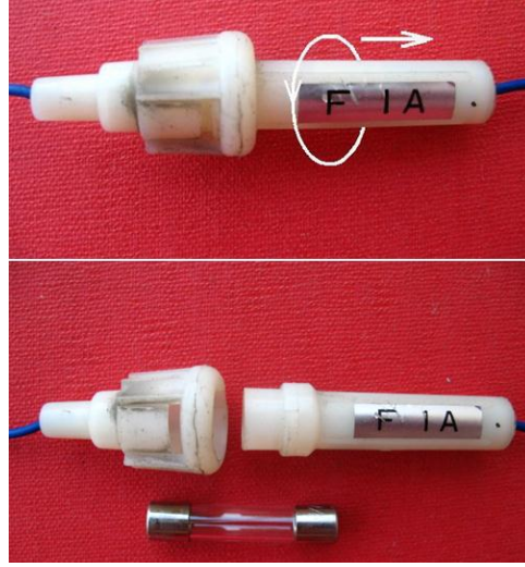
Resim 3.7: Kablo hattı üzerine yerleştirilmiş cam sigorta
