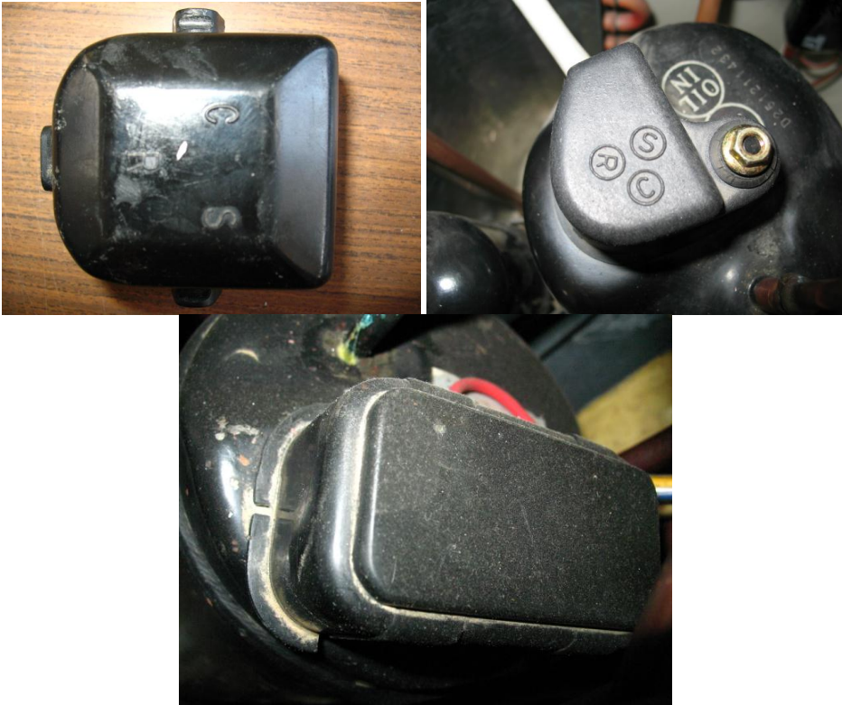
Resim 2.6: Farklı kompresör terminal kapakları
