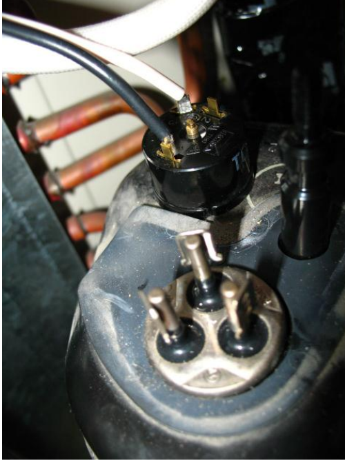
Resim 2.8: Farklı kompresör terminalleri
