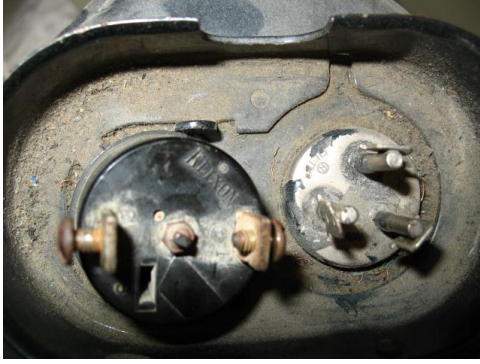
Resim 2.7: Farklı kompresör terminalleri (füzüt uçları)
