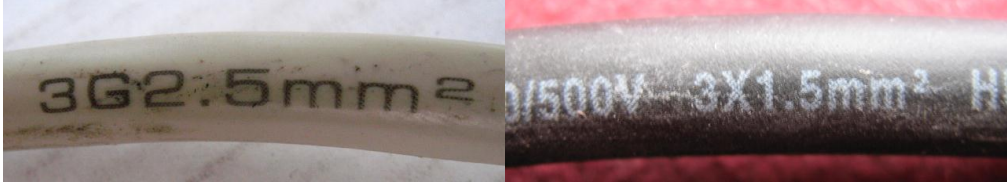
Resim 4.1: Besleme hattı kablosu damar sayısı ve kesit gösterimi
