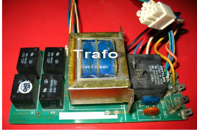
Resim 1.4: Kart besleme enerjisi bir trafo ile voltajı düşürülerek sağlanır.
