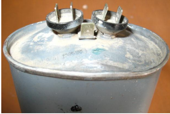
Resim 2.24: Göz ile arızasını tespit edebileceğimiz arızalı durumdaki kapasitörler
