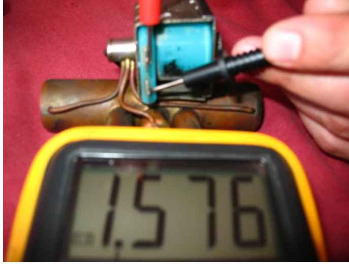
Resim 1.15: Solenoid bobinin avometre ile sađlamlık testi
