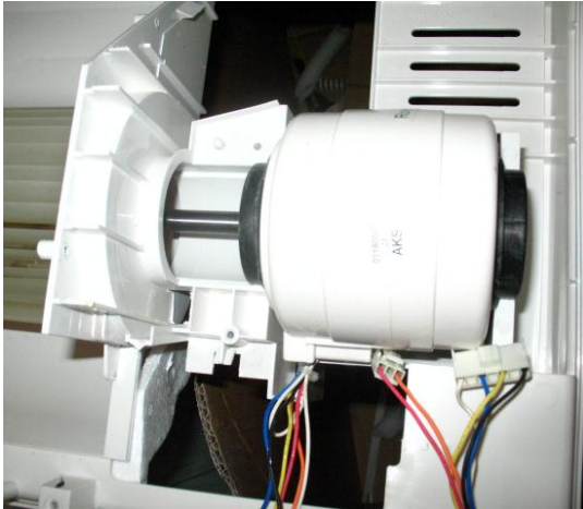
Resim 2.12: İç ünite fan motorunun montajlı şekli
