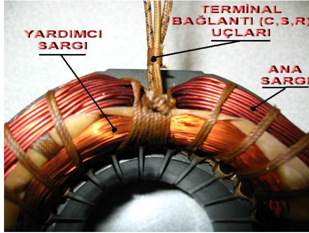
Resim 2.5: Stator ana ve yardımcı sargıları ve c, s, r bağlantı uçları
