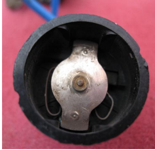
Resim 3.1: Terminiğin bi-metalinin ve rezistans telinin görünümü
