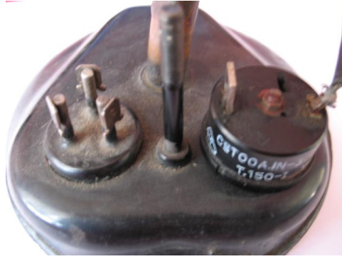
Resim 2.7: Farklı kompresör terminalleri (füzüt uçları)
