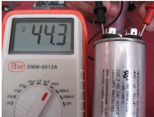
Resim 2.25: Kapasitemetre ile bir kapasitörün ölçülmesi ve etiket değeri ile kıyaslanması
