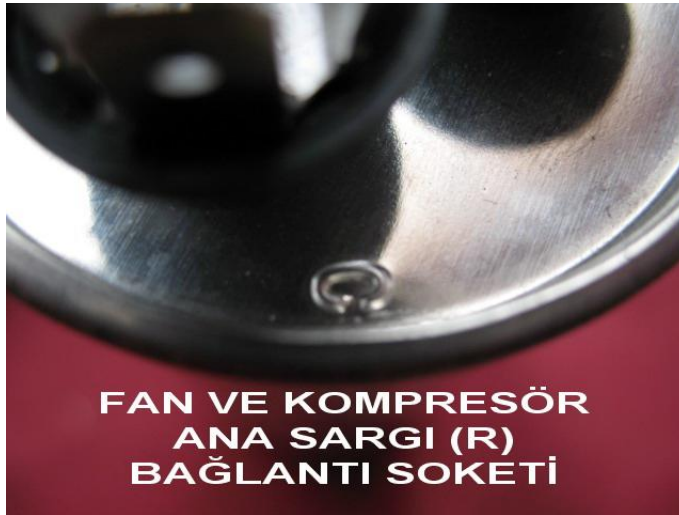
Resim 2.20: Üç uçlu kapasitörün fan ve kompresör bağlantı uçlarının gösterimi
