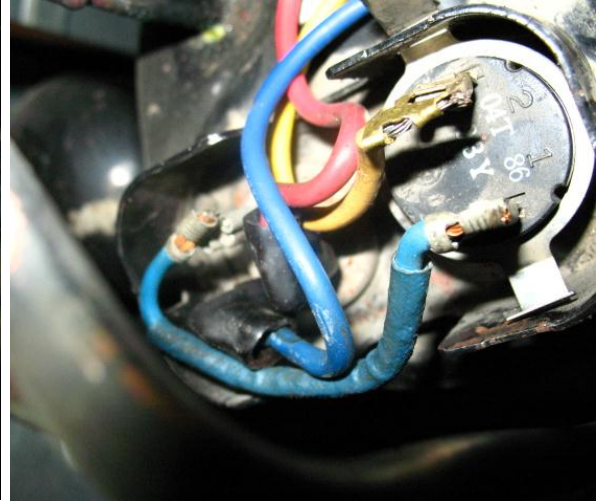
Resim 2.8: Farklı kompresör terminalleri
