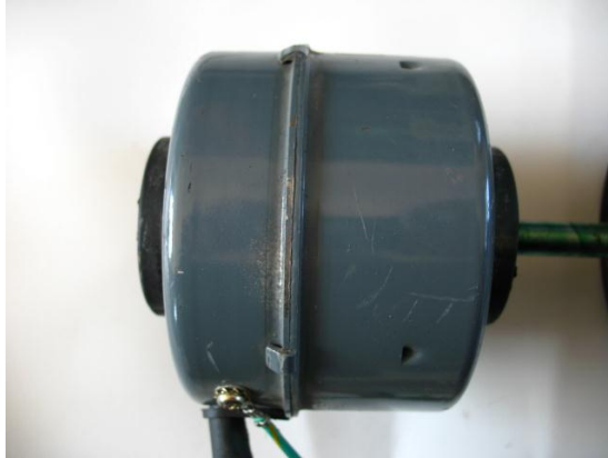
Resim 3.11: Gövdesi sökülemez tipte iç ünite fan motoru
