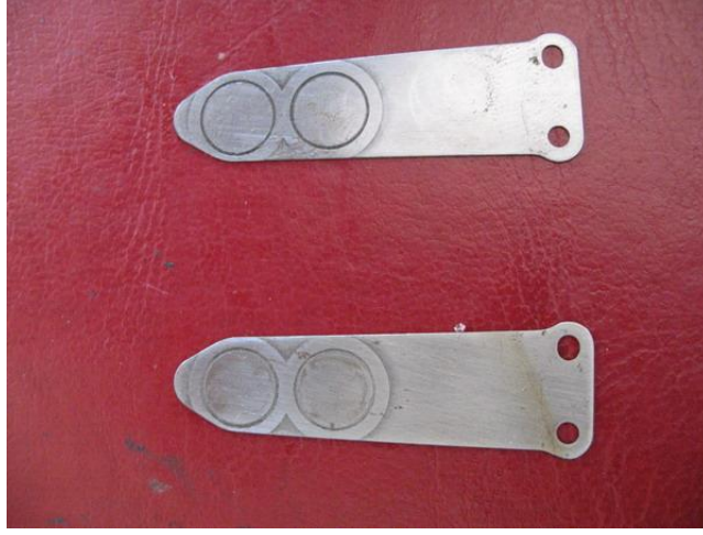
Resim 2.19: Basma valflerinde meydana gelen derin izler
