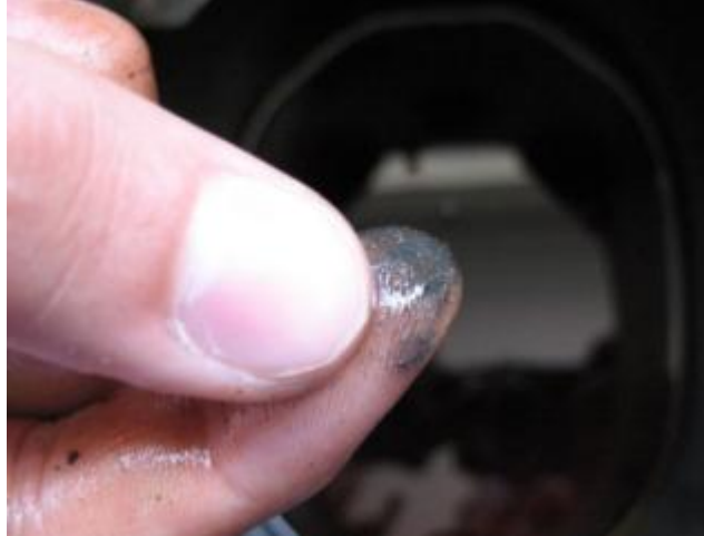
Resim 1.18: Kompresör yağı içinde birikmiş olan metalik tortu
