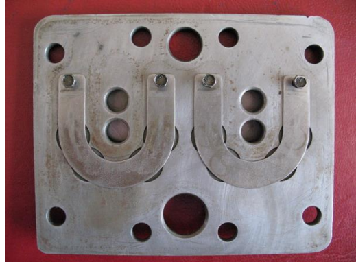
Resim 2.5: Valf pleytine montajlı emme valfi
