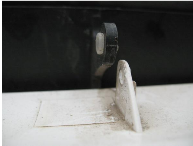
Resim 4.3: Destek yuvasının kırılması sonucunda arızalanmış flap
