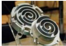
Resim 2.13: Scroll kompresörün hareketli ve sabit salyangoz parçaları
