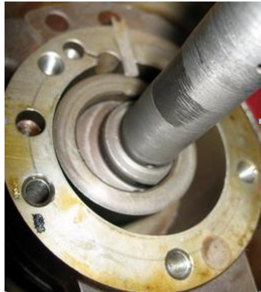
Resim 2.7: Dönel tip kompresörün basma anı
