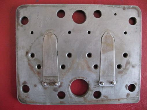
Resim 2.4: Valf pleytine montajlı basma valfi
