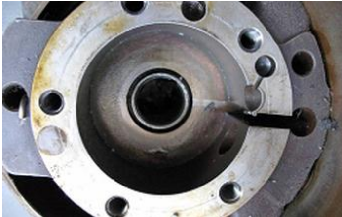
Resim 2.9: Dönel tip kompresörün silindiri
