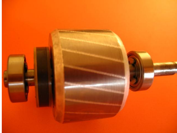
Resim 3.13: Fan motor milinin yataklamasında kullanılan rulmanlar
