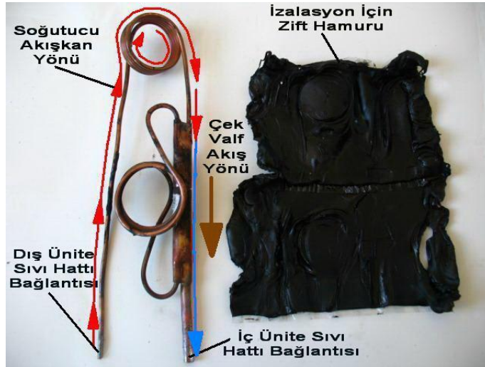
Resim 5.4: Çek Valfin yaz konumunda çalışması
