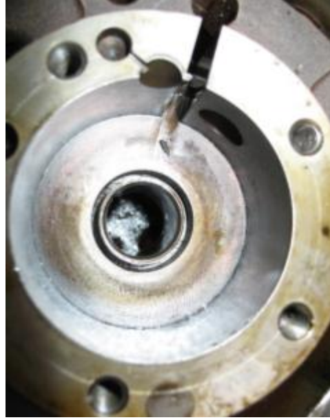
Resim 2.15: Kompresör silindir tabanındaki bakır kaplanmasının görülmesi
