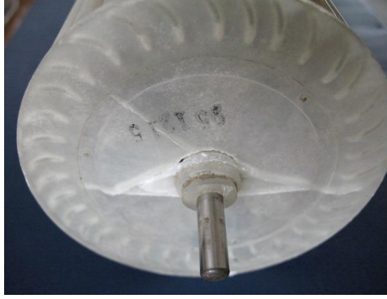
Resim 3.9: İç ünite radyal fan milin bağlantı yerinden çatlaması
