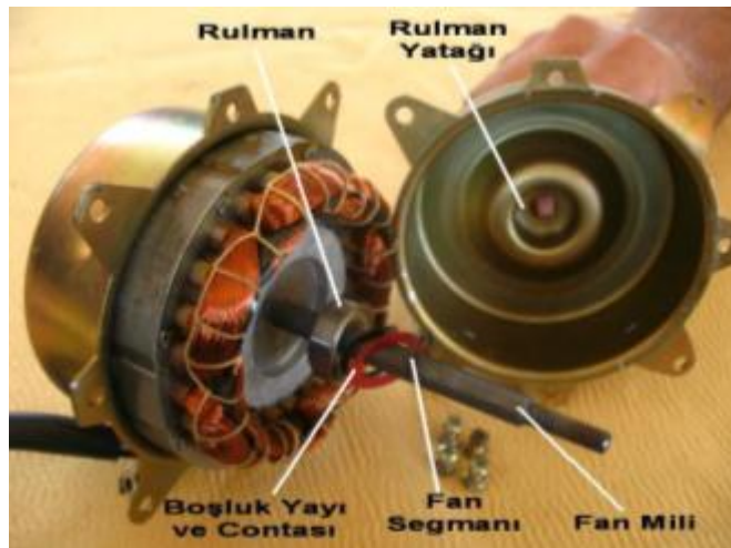
Resim 3.5: Dış ünite fan motoru iç yapısı
