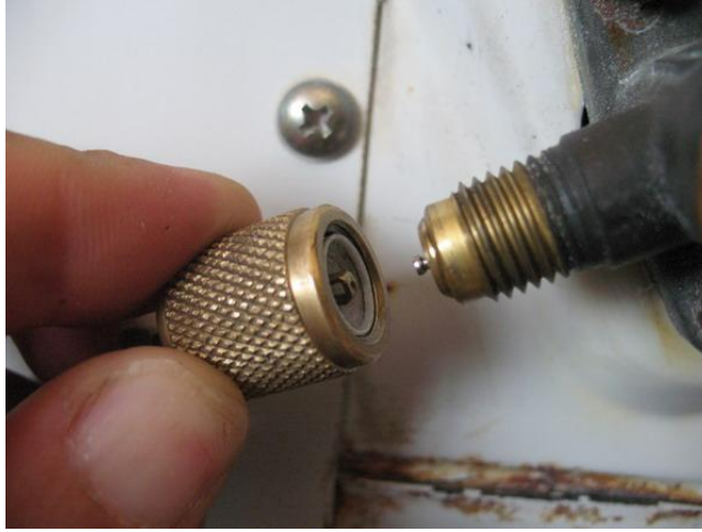
Resim 1.4: Siboplu servis ucuna iğneli gaz hortum bağlantısı
