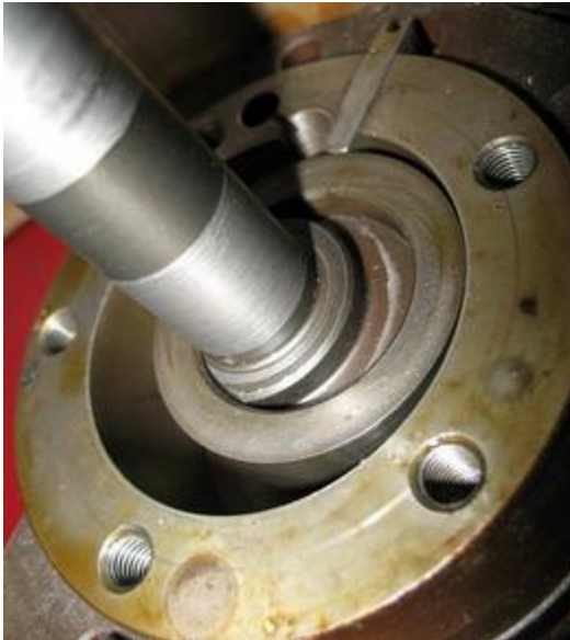
Resim 2.6: Dönel tip kompresörün emme anı
