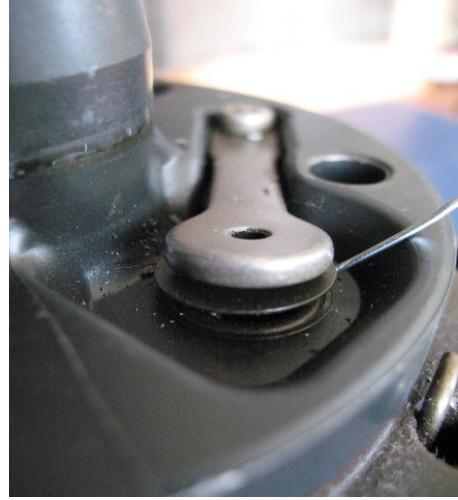
Resim 2.12: Dönel tip kompresöre ait basma valfi
