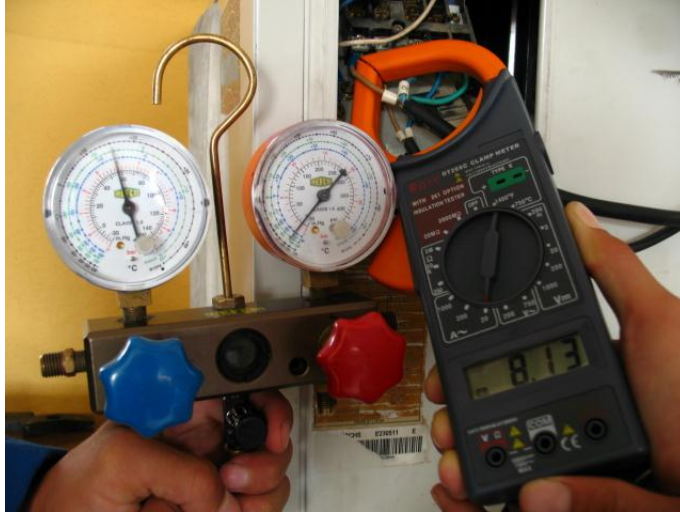
Resim 2.20: Soğutma konumunda cihazın basınç ve çalışma akımının gözlemlenmesi
