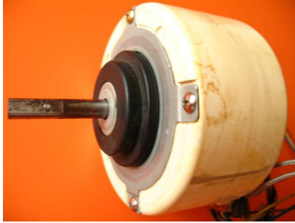
Resim 3.12: Sökülebilir gövdeli iç ünite fan motoru
