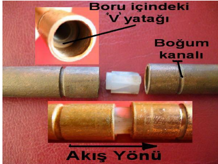
Resim 5.6: İç sürgüsü plastik malzemeli çek valf
