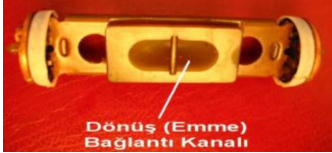
Resim 5.13: Gazın dönüş (emme) yoluna bağlantı sağlaya plastik kanal
