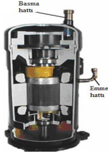
Resim 2.14: Scroll ( Salyangoz) kompresörün kesit ve emme-basma borularının görünümü
