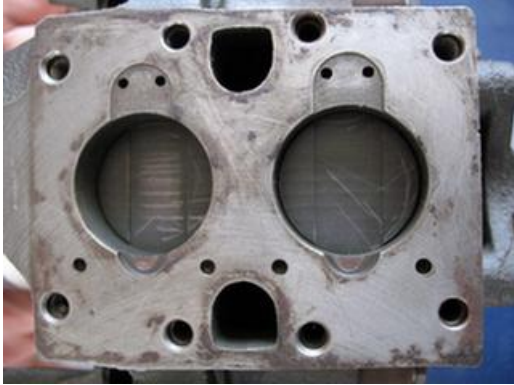
Resim 2.2: Silindir içerisinde çalışan pistonlar
