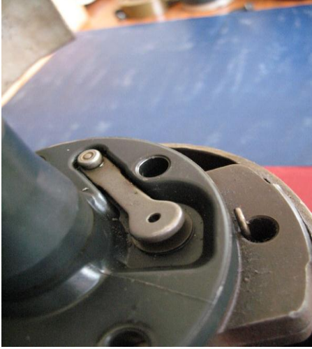
Resim 2.12: Dönel tip kompresöre ait basma valfi
