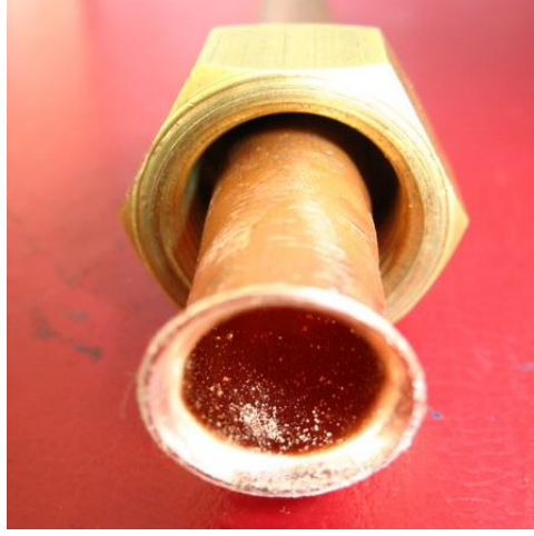
Resim 2.16: Bakır boru iç yüzeyine yapışmış talaş ve çapak kalıntıları
