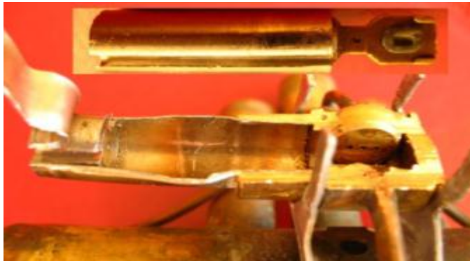
Resim 5.15: Pilot basınçlarını geçiş yaptığı hassas delikler ve pilot gaz basıncına yön veren demir nüveye montajlı plastik kanal
