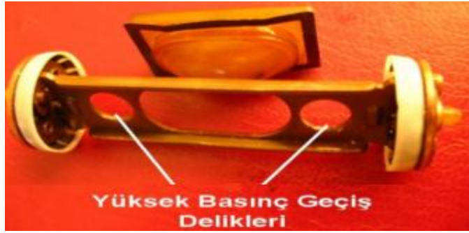
Resim 5.14: Dört yollu valf içerisindeki hareketli piston
