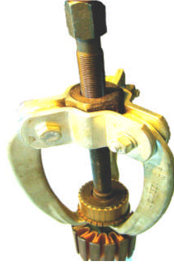
Resim 2.7: Kolektörün çektilme ile sökölüşü
