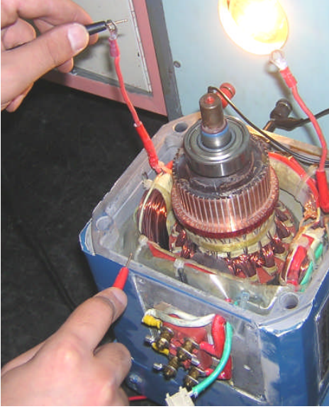
Resim 3.5: Endüktör sargısından gövdeye kaçak var
