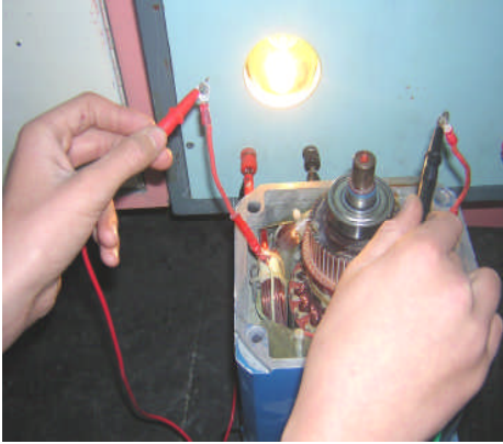
Resim 3.3: Endüktör sargısı sağlam
