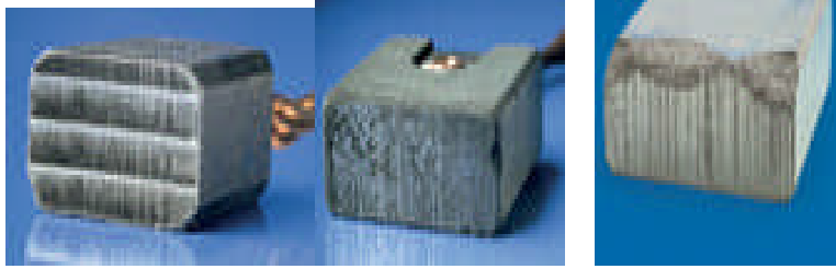
Resim 2.4: Kolektör yüzeyi arızalarının fırçalar üzerindeki olumsuz etkileri
