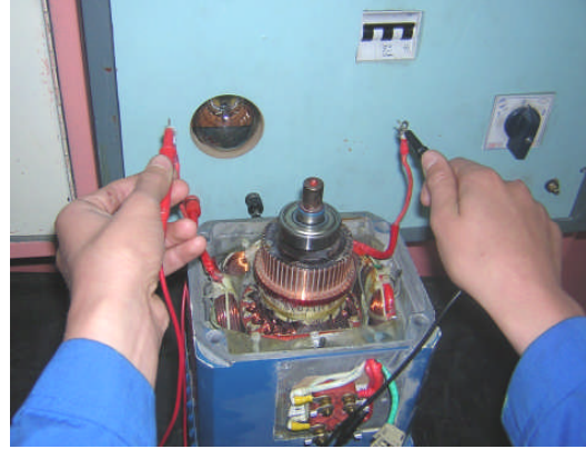
Resim 3.4: Endüktör sargısı kopuk
