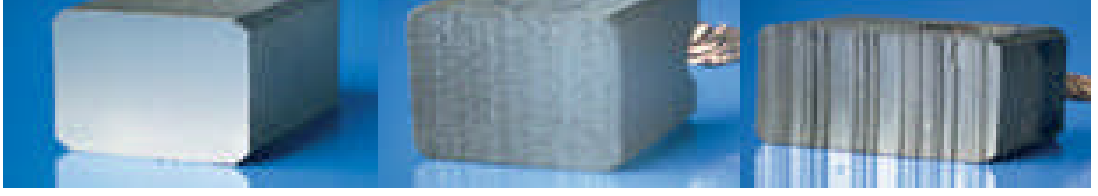
Resim 1.4: Normal aşınma Resim 1.5: Tozlu ortamın etkisi Resim 1.6: Yağlı ortamın etkisi
