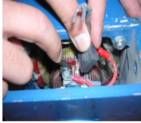
Resim 1.12: Fırçanın yuvasına takılması
