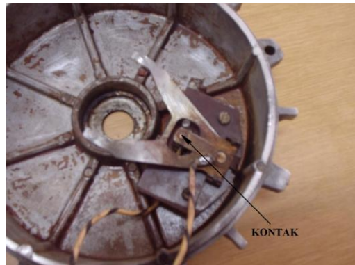
Resim 3.4: Merkezkaç anahtarının kontakta
