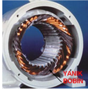
Resim 1.29: Yanmış stator sargıları
