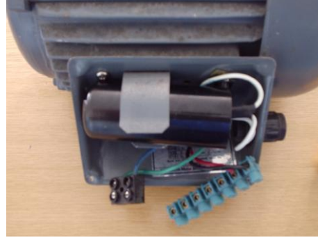
Resim 2.2: 1~ motora bağlanmış kondansatör
