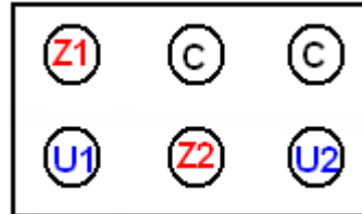
Şekil 1.12: Bir fazlı motorların standart klemens tablosu
