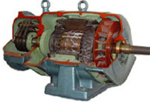
Resim 1.4: Sargılı rotorlu ( bilezikli ) asenkron motor
