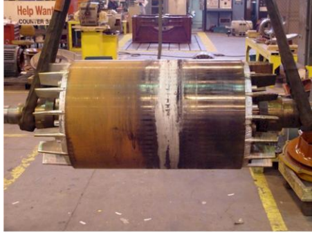
Resim 4.2: Kısa devre çubukları kırılmış bir rotor
