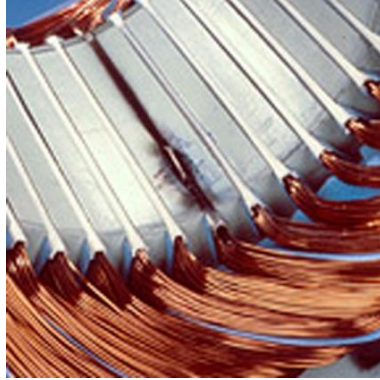
Resim 1.22: Oyuk içinden gövdeye kaçak
