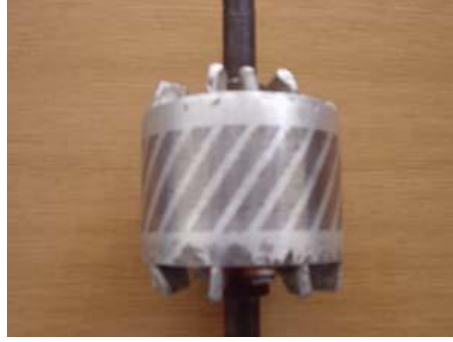
Resim 5.1: Asenkron motorun kısa devre çubuklu rotoru
