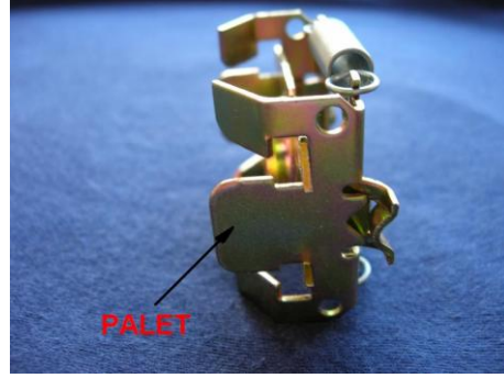
Resim 3.8: 3000 devirde kullanılan palet
