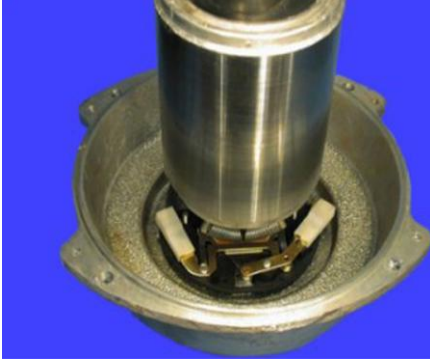
Resim 1.15: Kapağa montajlı merkezkaç anahtarı Resim 1.16: Rotor üzerindeki hareketli parça
