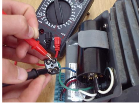
Resim 1.13: Bir fazlı motor sargı kontrolü
