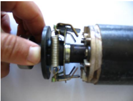
Resim 3.1: Merkezkaç anahtarı hareketli parça
