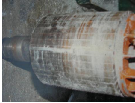
Resim 4.3: Kısa devre çubukları gevşemesinden dolayı arızalanan bir rotor
