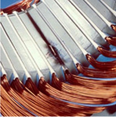
Resim 1.7: Oyuk içinden gövdeye kaçak
