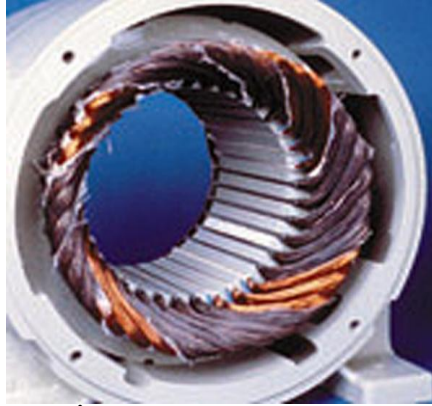
Resim 1.17: İki faza kalarak yanan stator sargıları
