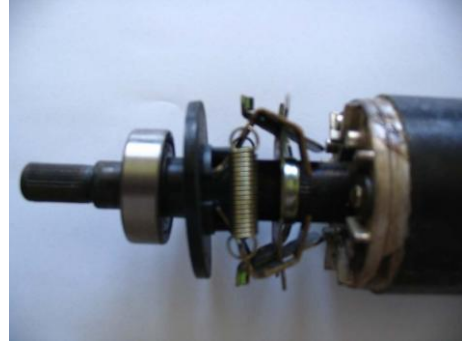
Resim 1.15: Kapağa montajlı merkezkaç anahtarı Resim 1.16: Rotor üzerindeki hareketli parça
