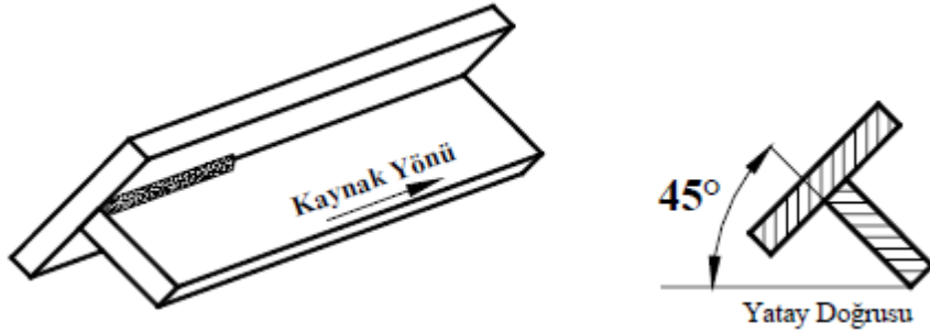
Şekil 3.1: Yan (duvar) iç köşe kaynağı
