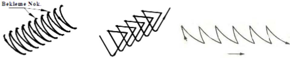
Çizim 1.2: Yan (duvar) kaynağında elektrot hareketi
