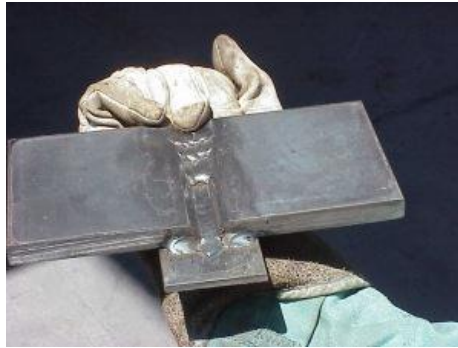
Resim 4.2: Altlık konulup kaynatılmış iş parçası
