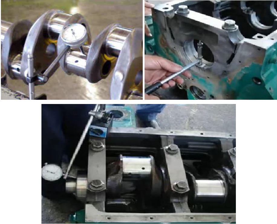
Resim 1.1: Komparatör ile krank mili ölçümleri
