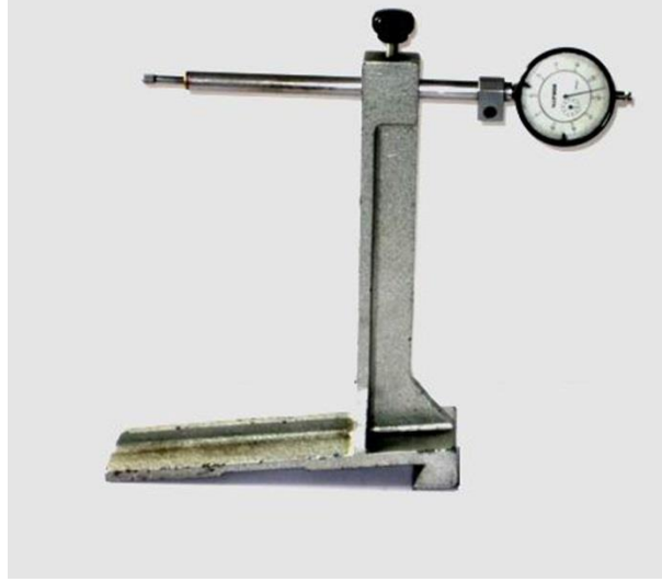
Resim 3.8: Ayarlama (merkezleme) sehпасı ve komparatörü
