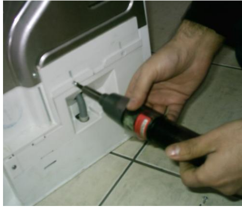
Resim 3.1: Kurutma makinesinin su haznesinin sökülmesi
