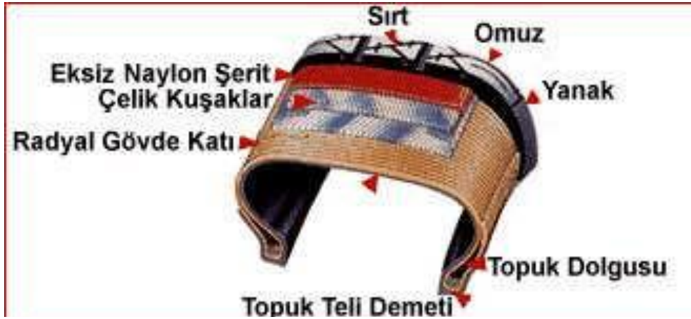
Resim 1.13: Lastiğin iç yapısı ve kısımları
