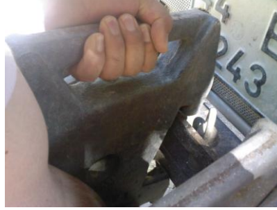
Resim 5.2: Traktöre ön ağırlık takılması
