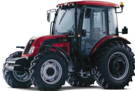
Resim 5.1: Traktörün önüne ve arka lastiğe takılı ek ağırlık görünümü
