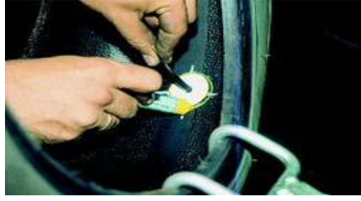
Resim 3.5: Yamannın kaplayacağı yerin işaretlenmesi
