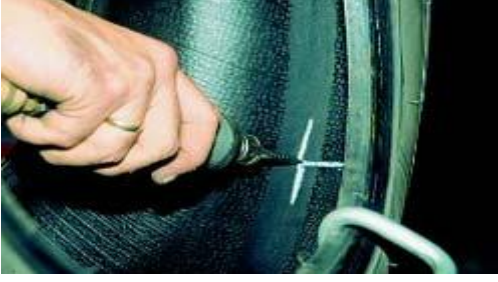
Resim 3.4: Lastikteki deliklerin genişletilmesi
