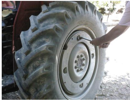
Resim 5.3: Lastikteki ek ağırlığın sökülmesi
