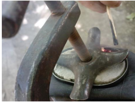
Resim 3.1: Lastiğe sıcak kaynak uygulaması
