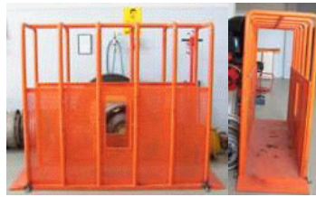
Resim 1.21: Lastiklere hava vurma için kullanılan emniyet kafesi
