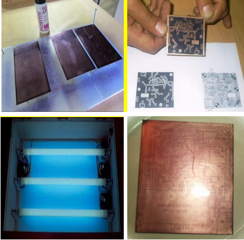
Fotoğraf 3.1: Foto Rezist yöntemi ile pozlandırma
