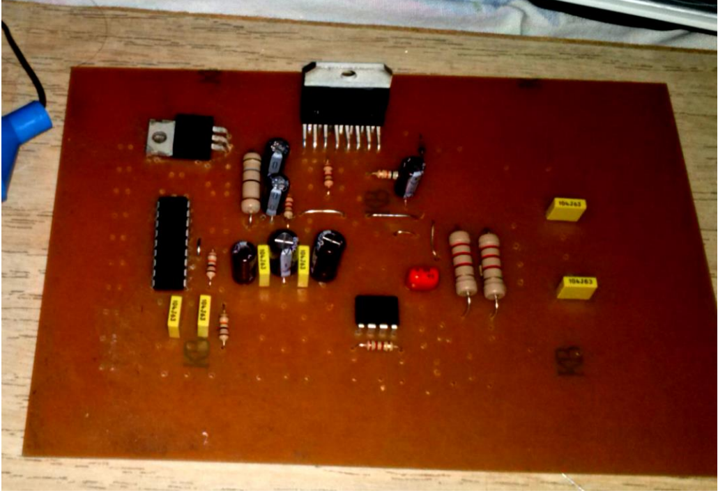
Fotoğraf 3.8: Malzemelerin plakete montaj edilmesi
