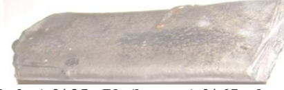
Resim 1.6: Sn (kalay) %35, Pb (kurşun) %65, alaşımli lehim çubuk
