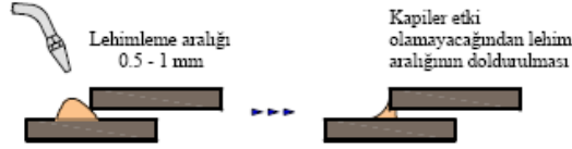
Şekil 2.5: Lehim kaynağı işlemi
