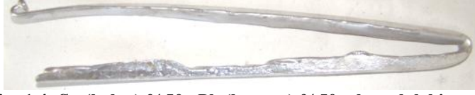
Resim 1.4: Sn (kalay) %50, Pb (kurşun) %50, alaşımli lehim çubuk
