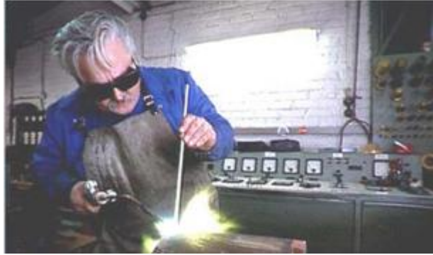
Resim 2.3: Sert lehim tekniğinin uygulanışı
