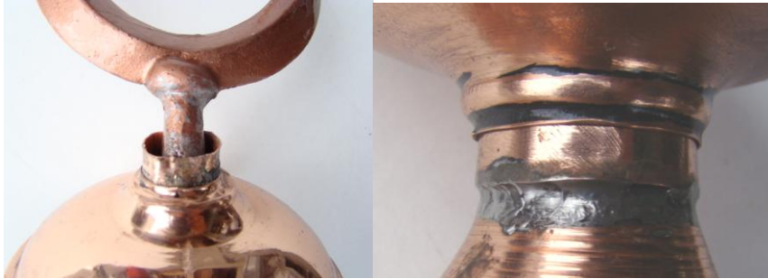
Resim 1.22: Bronz başlıkta bindirme boru ve bindirme sac lehimleri
