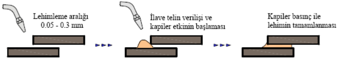
Şekil 2.3: Kapiler etki ile lehimleme işlemi
