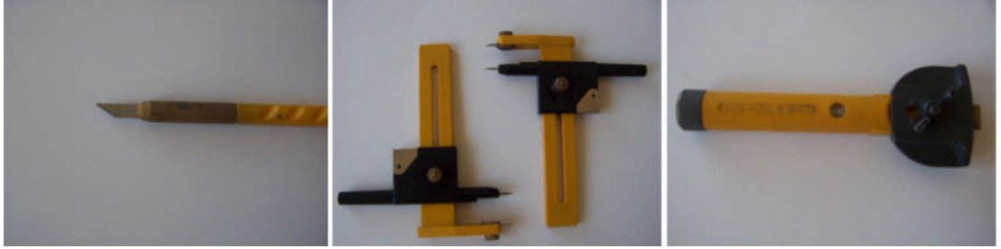
Resim 2.4: a) Kalem maket bıçağı b) Daire maket bıçağı c) Boşaltma (boşluk açma) maket bıçağı
