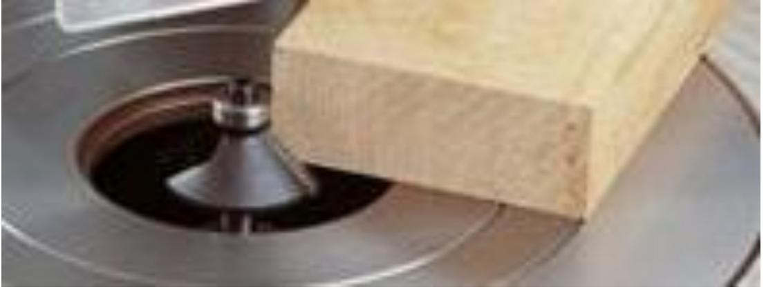
Resim 1.31: Kısa milde rulmanlı bıçakla profil açma
