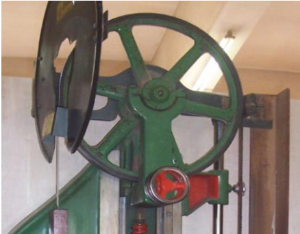
Resim 1.6: Üst kasnak, öne arkaya eğim ve gergi ayar kolu
