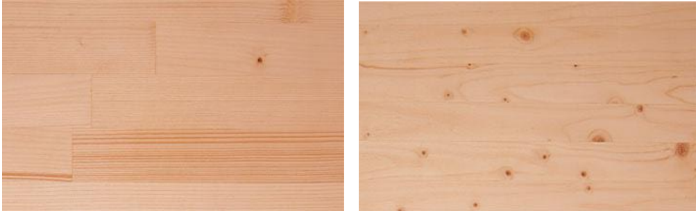
Resim 2.5: Boy eklemeli ve boy eklemesiz masif panel
