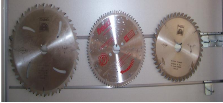
Resim 2.13: Daire testere makinesi elmas uçlu daire testere lamaları
