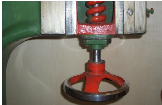
Resim 1.6: Üst kasnak, öne arkaya eğim ve gergi ayar kolu
