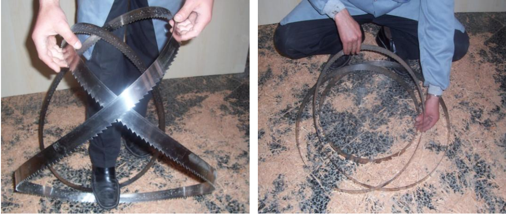
Resim 1.10: Testere lamasının katlanması
