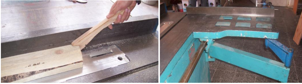
Resim 2.12: İtme çubuğu ve arabalı tabla
