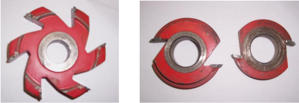
Resim 2.15: Daire testereye takılan top bıçaklar
