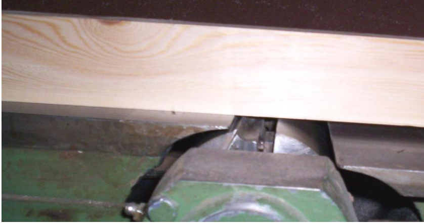
Resim 1.6: Planya makinesi bıçaklarını sökerken ön tabla
