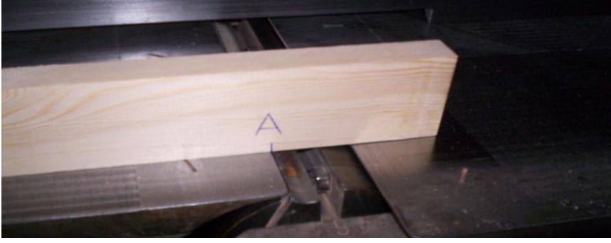
Resim 1.8: Planya makinesinin bıçaklarının ayarlanması
