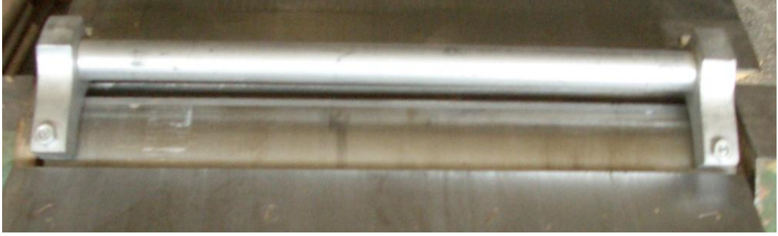
Resim 1.10: Planya makinesinin bıçağının ayarlanmasında kullanılan ayar köprüsü
