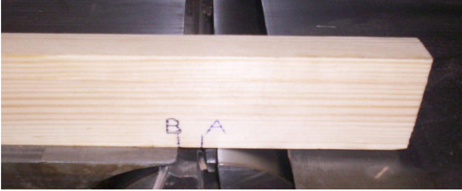
Resim 1.9: Planya makinesinin bıçaklarının ayarlanması
