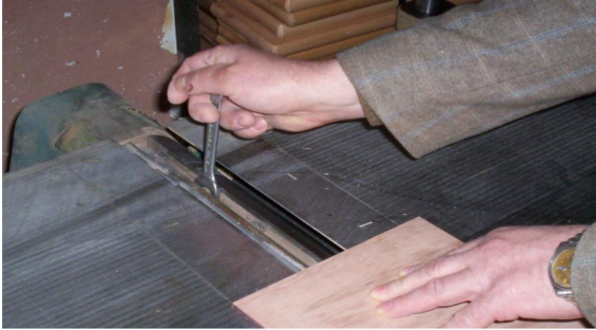
Resim 1.7: Planya makinesinin bıçaklarının sökülmesi
