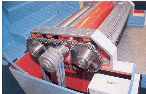
Resim 2.3: Kesiciler, silindirler ve baskı kirişi
