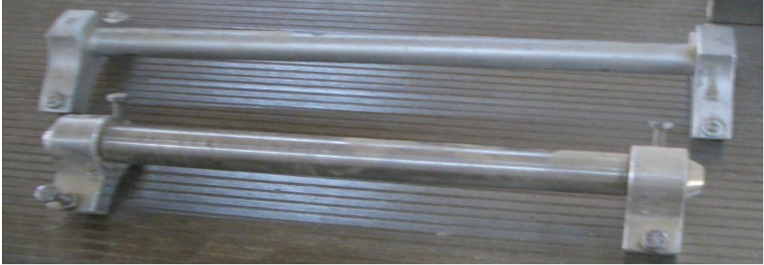
Resim 1.11: Planya makinesinin bıçağının takılmasında kullanılan ayar köprüsü
