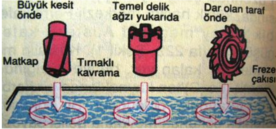
Resim 2.1: Sertleştirmede sıvı içerisine parçaların doğru daldırılması
