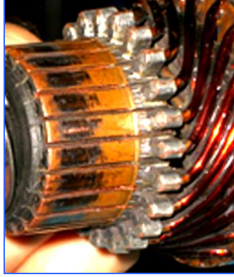
Resim 3.3: Kollektör dilimlerinin yapısı
