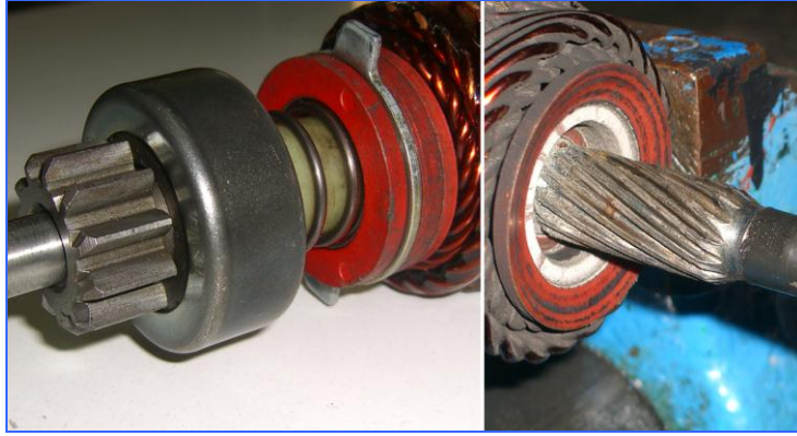
Resim 3.5: Marş dişlisi-tek yönlü kavrama-helisel kanallar
