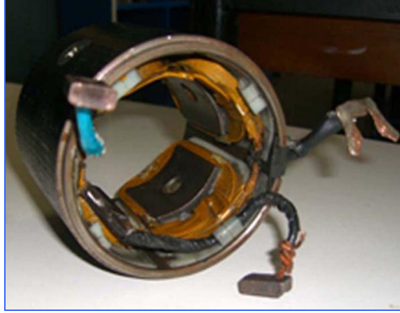
Resim 3.1: Elektromıknatıslı endüktörün yapısı
