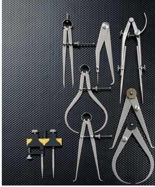
Fotoğraf 1.1: Markalamada kullanılan pergel ve çap kumpasları
