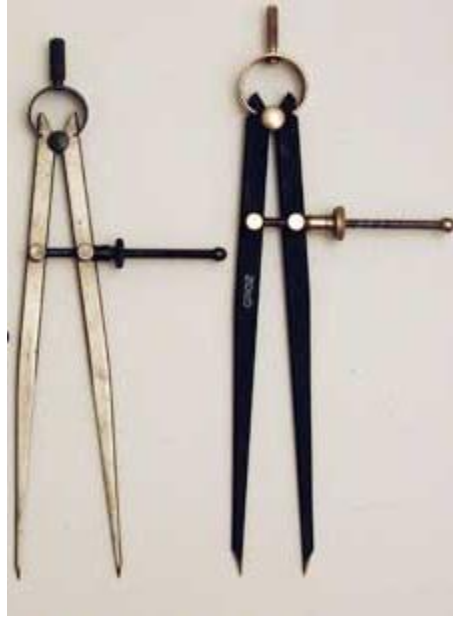
Fotoğraf 2.1: Pergel uçlarının paralellikleri
