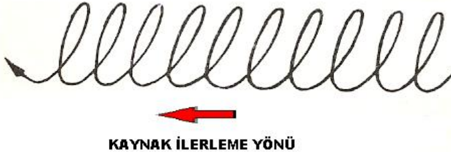
Şekil 3.3: Duvarda küt ek kaynağı elektrot hareketi
