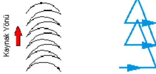
Şekil 1.5: Torç hareketi ve açısı
