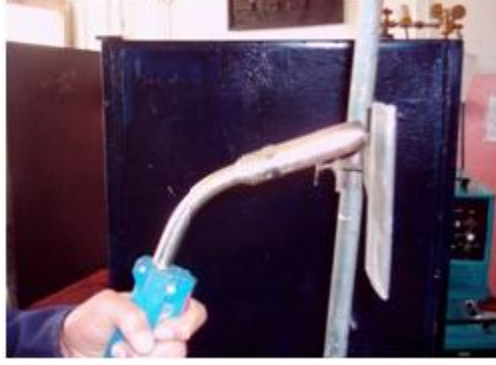
Resim 1.1: Yukarıdan aşağı kaynaktaki torçün konumu
