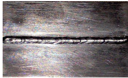
Resim 2.4: Temizlenmiş kaynak görünümü
