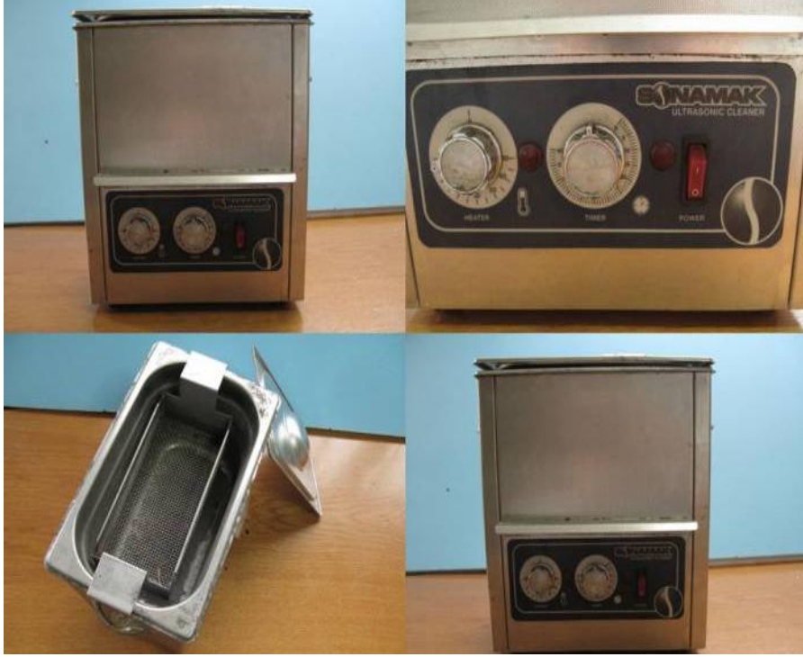
Resim 1.8: Pipet vb. yıkama amaçlı üretilmiş ultrasonik yıkama cihazları
