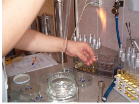
Resim.7.1: Alev altında sterilizasyon
