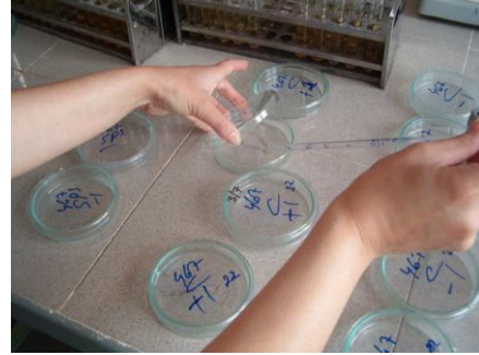
Resim 2.8: Pipetten petri kutusuna aktarma
