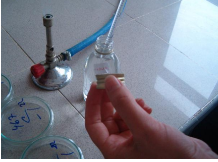
Resim 2.7: Numunenin pipete çekilmesi
