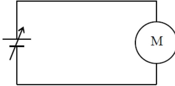
Şekil 2.6: DC motorun ayarlı güç kaynağı ile hız kontrol devresi
