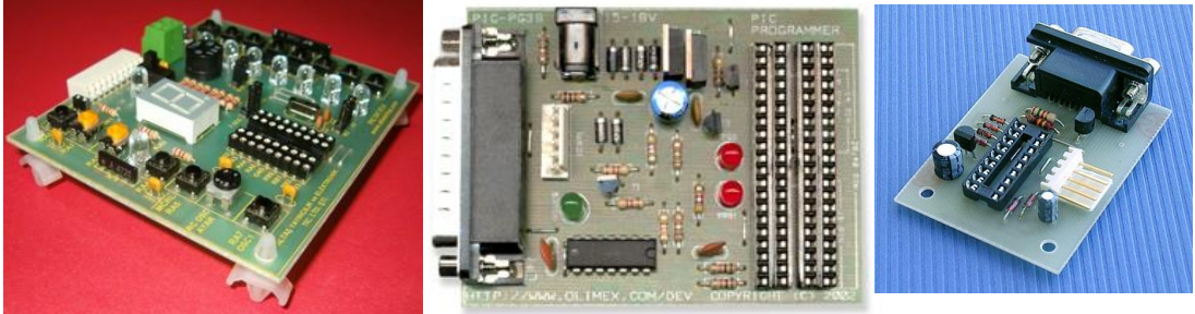
Şekil 2.1: Mikrodenetleyici programlama ve deneme kartı görüntüleri
