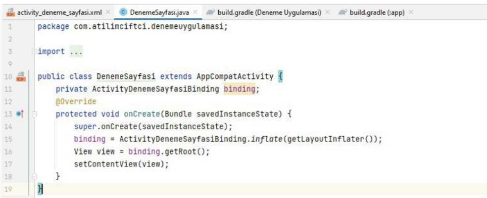
Görsel 6.20: Activity'de viewBinding etkinleştirme
