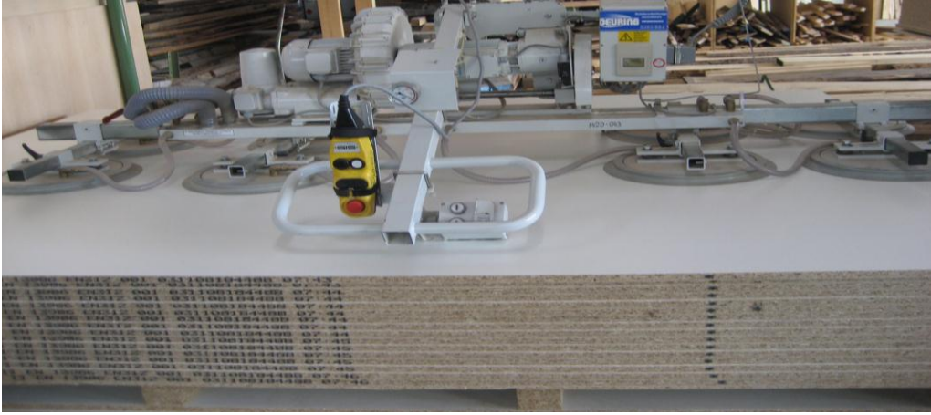
Resim 2.3: Plakaları vakumlayarak taşıyan ebatlama makinesi
