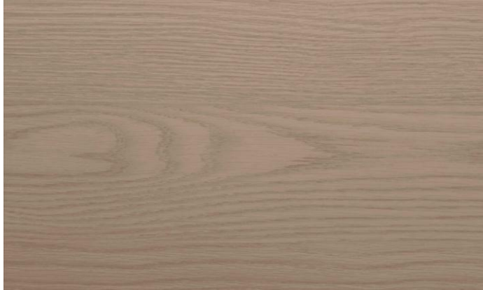
Resim 1.1: İş parçalarının kesileceği 183x366 cm ölçülerinde suntalam plakası
