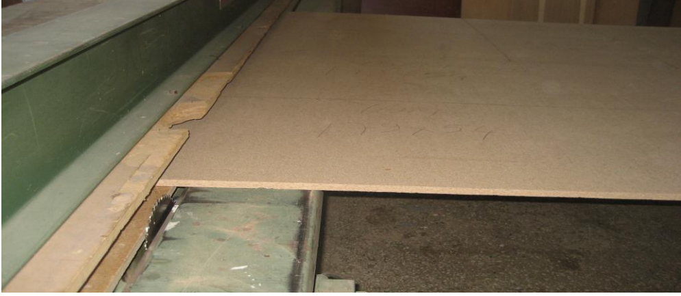
Resim 2.2: Sunta ebatlama makinesinde kaba kesim yapma
