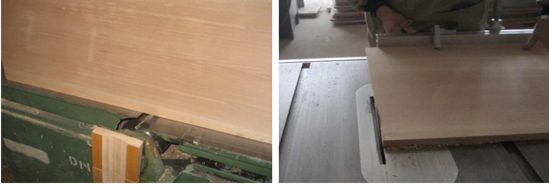
Resim 2.5: Kaplamalı iş parçalarını net ölçüsüne getirme
