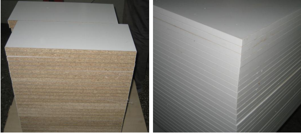
Resim 2.4: Net ölçüsüne getirilmiş ve kenarları kapatılmış iş parçaları
