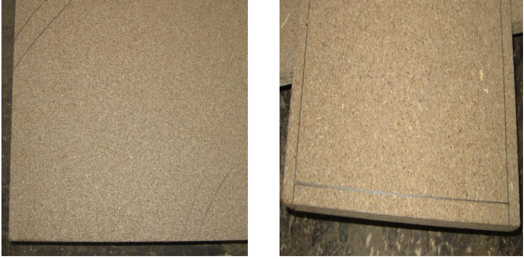
Resim 1.8: Kaplanacak sunta kenarının işaretlenmesi
