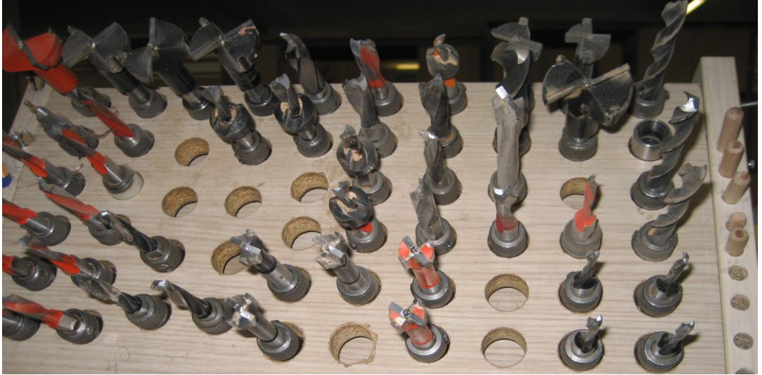
Resim 2.2: Çoklu delik makinesi kesicileri
