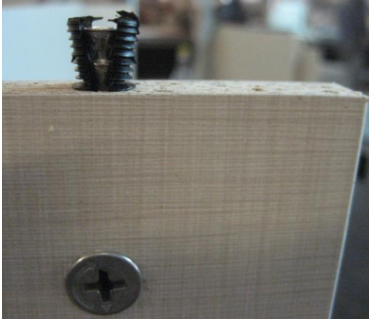
Resim 2.6: Minifixlerin tablaya takılması
