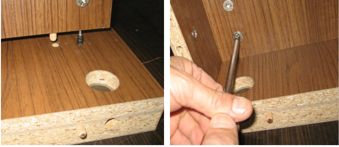
Resim 2.16: Tablaların birleřtirilip minifixlerin sıklması
