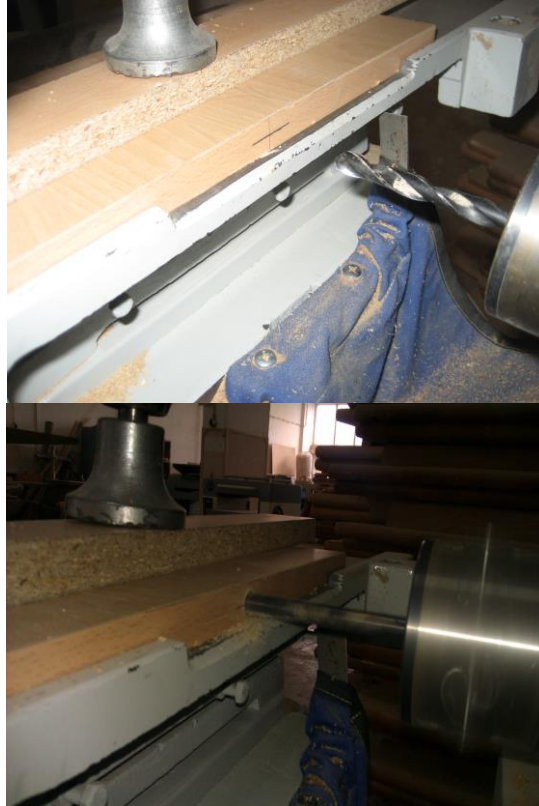
Resim 3.4: Kavela deliklerinin yatay delik makinesinde delinmesi
