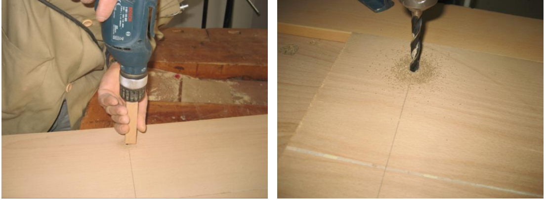
Resim 3.3: Kavela deliklerinin el breyizi ve dikey delik makinesinde delinmesi
