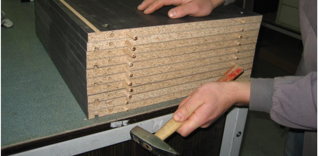
Resim 2.4: Kavelaların tablolara çakılması
