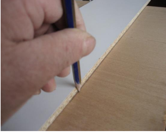
Resim 3.2: Kavela yerlerinin markalanması
