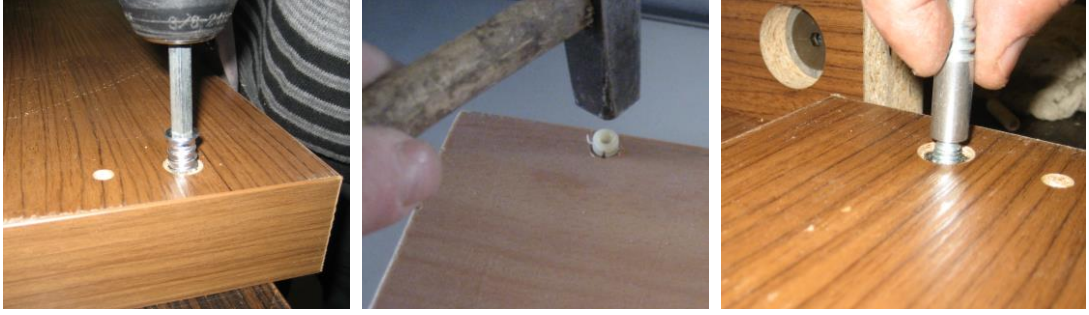
Resim 2.15: Tablalara minifix kavelalarının takılışı
