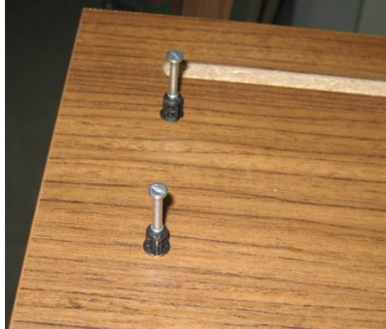
Resim 2.6: Minifixlerin tablaya takılması
