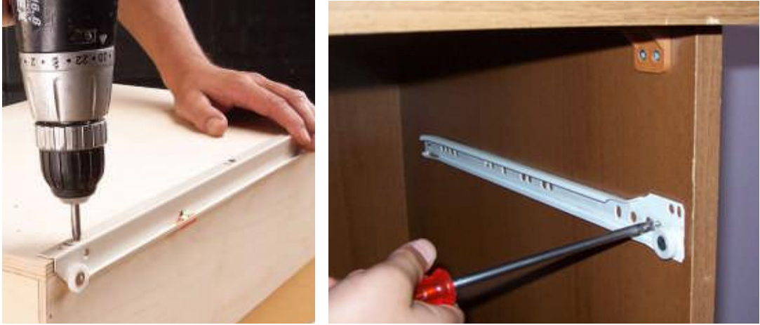
Resim 2.8: Çekmece raylarının takılması
