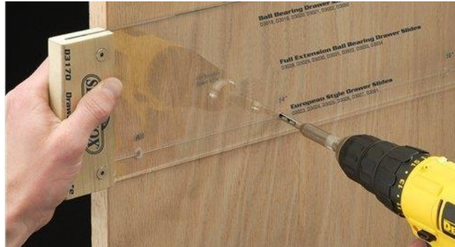
Resim 1.5: Minifix bağlantı elemanları yerlerinin şablonla markalanması
