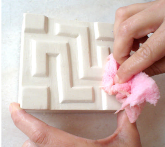
Resim 1.4: Alçı modeli gomalak ile yalıtma
