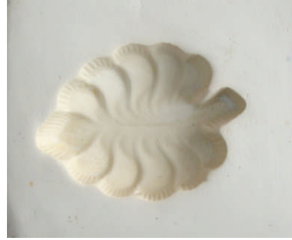
Resim 3 .8: Tek parçalı yaprak model kalıbı
