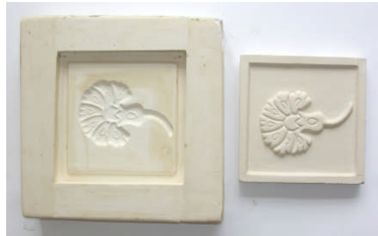
Resim 3 .4: Karanfil modeli ve kalıbı
