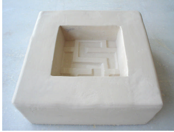
Resim 3. 1: Tek parçalı modüler pano kalıbı
