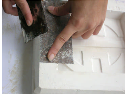
Resim 4.4: Kalıbın kenar ve köşelerini pahlama
