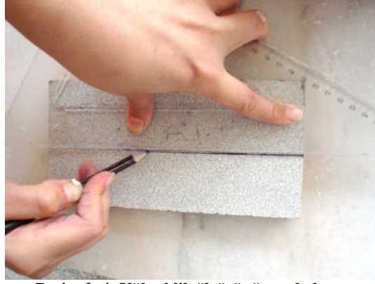
Resim 2 .4: Yükseklik ölçüsünü markalama
