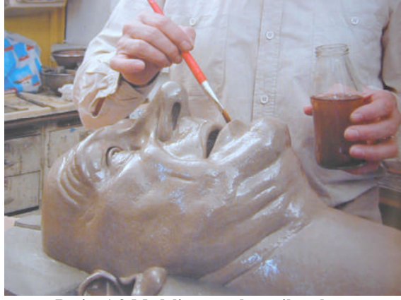
Resim 1.3:Modeli arap sabunu ile yalıtma
