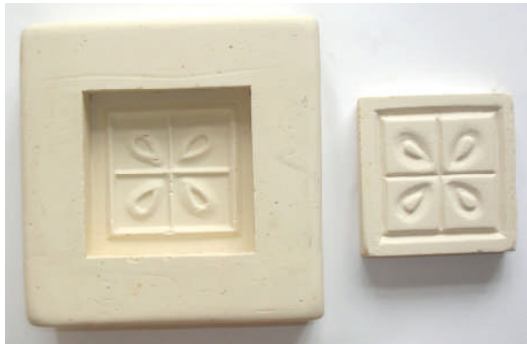
Resim 3. 3: Modüler pano modeli ve kalıbı
