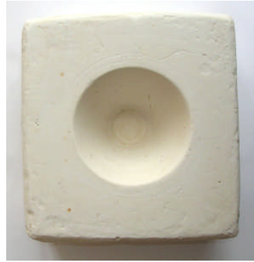
Resim 3. 9: Tek parçalı reçellik kalıbı
