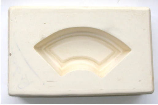
Resim 3. 7: Tek parçalı çerezlik kalıbı
