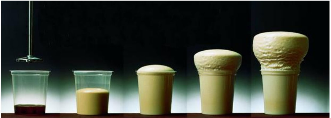
Resim 3.4: Poliüretan Oluşma Evreleri
