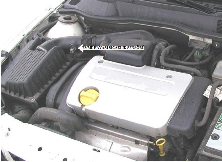
Şekil 2.4: Emme havası sıcaklık sensörünün motor üzerindeki yeri
