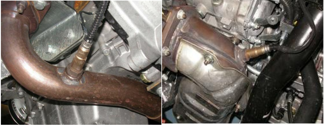
Şekil 6.4: Oksijen (lamda) sensörünün motor üzerindeki yeri
