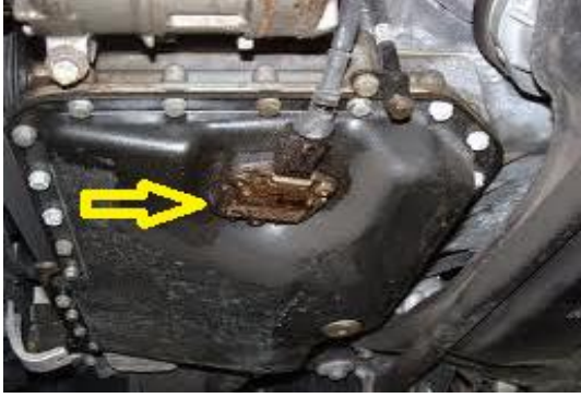
Şekil 14.3: Motor yağı seviye sensörünün motor üzerindeki yeri
