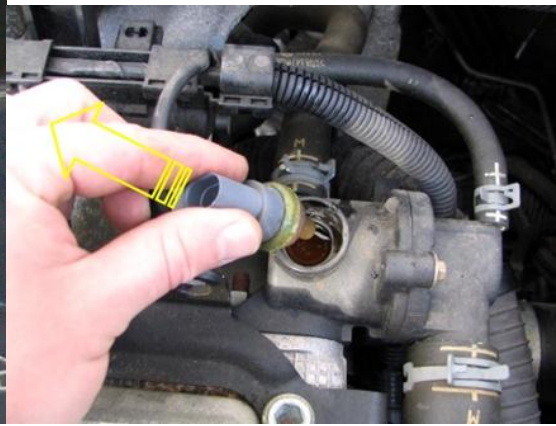
Resim 1.4: Sıcaklık müşirinin yerinden sökülmesi
