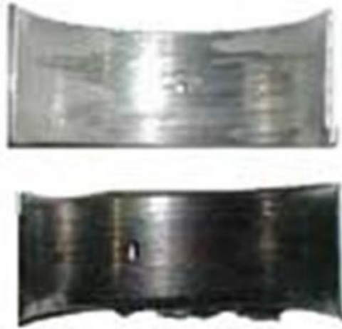
Resim 2.5: Yetersiz Yağlama Sonucu Aşınmış Yatak
