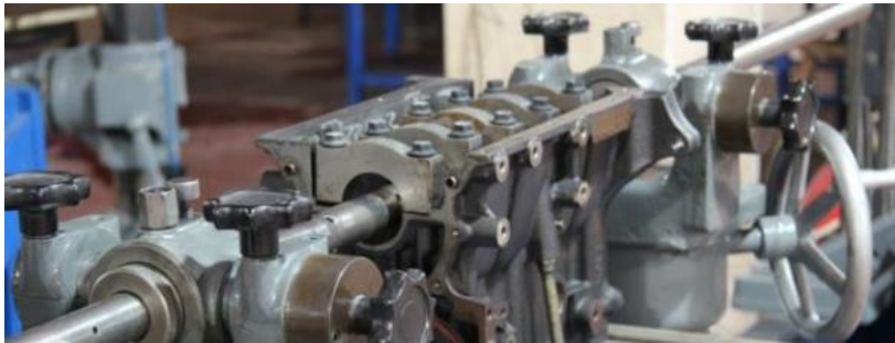
Resim 3.2: Sabit ana yatak tornası (Ana yatak barası)
