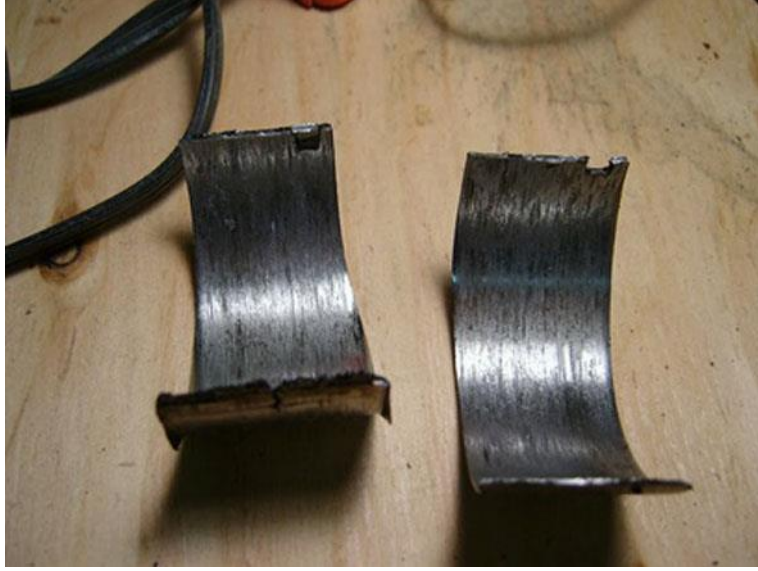
Resim 2.6: Kenar çıkıntısı aşınmış yatak
