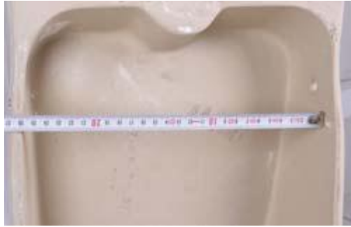
Şekil 4.15: Arkadan su girişli pisuvar L montaj parçası ölçüsü alınması
