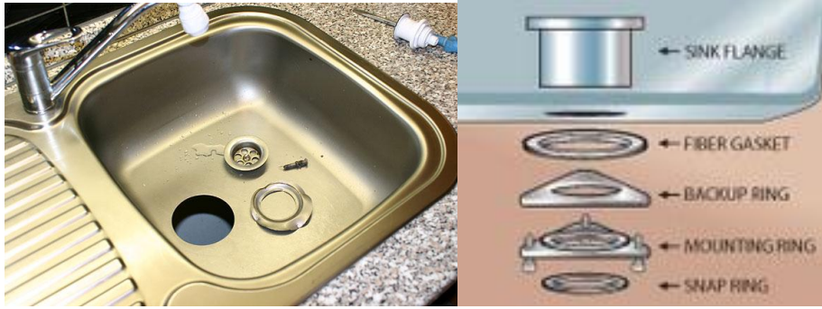
Şekil 1.26: Eviye sifon ağzının açılması
