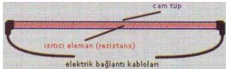
Resim 4.1: Defrost rezistansı elektrik kabloları
