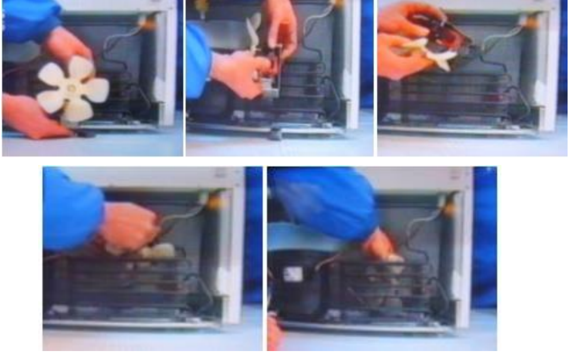
Resim 2.5: Yeni kondenserfanının yerine monte edilmesi
