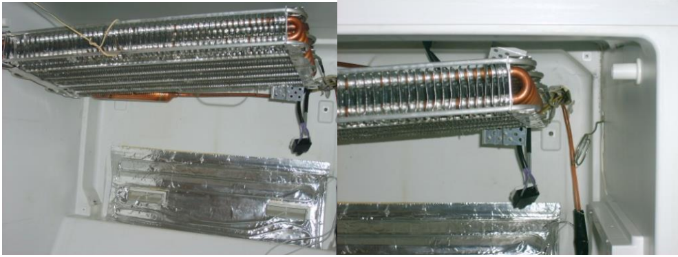
Resim 3.1: Fin tipi evaporatörün deęiřimi
