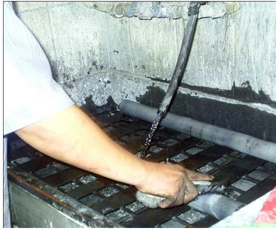
Resim 2.6: Su merdanesinin temizlenmesi
