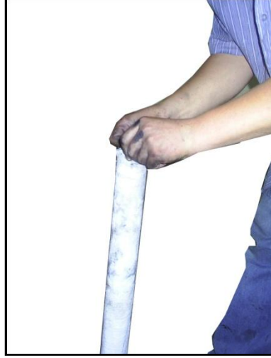
Şekil 2.11: Merdaneye kılıf takma
