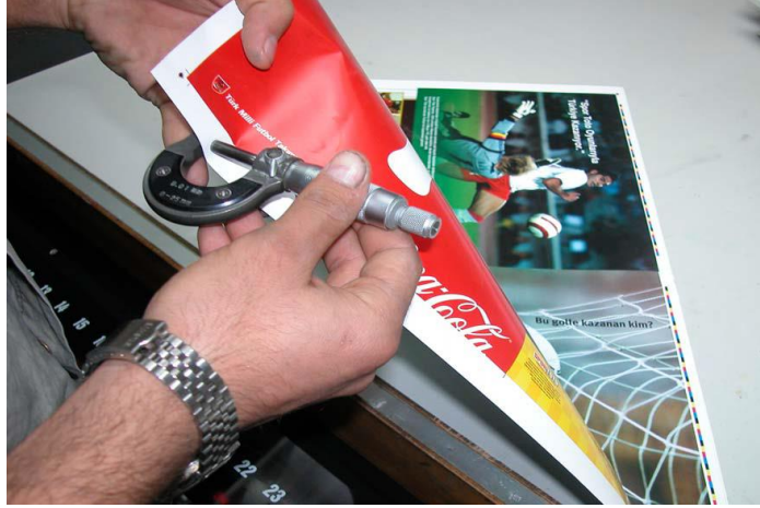
Resim 1.15: Mikrometre ile ölçüm
