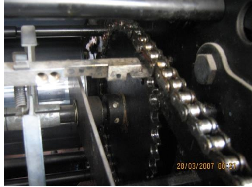
Resim 2.9: Zincirler ve dişliler için grease yağı
