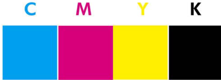
Şekil 1.12: Baskı kontrol şeridindeki zemin yoğunluğu kutucukları
