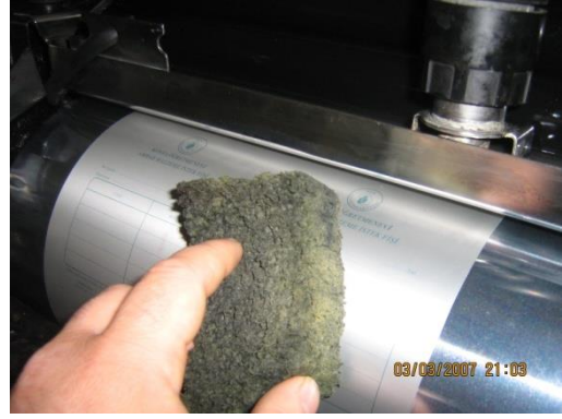
Resim 2.8: Kalıp temizleme işlemi
