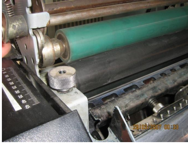
Resim 2.5: Su haznesi sökülmüş ünite
