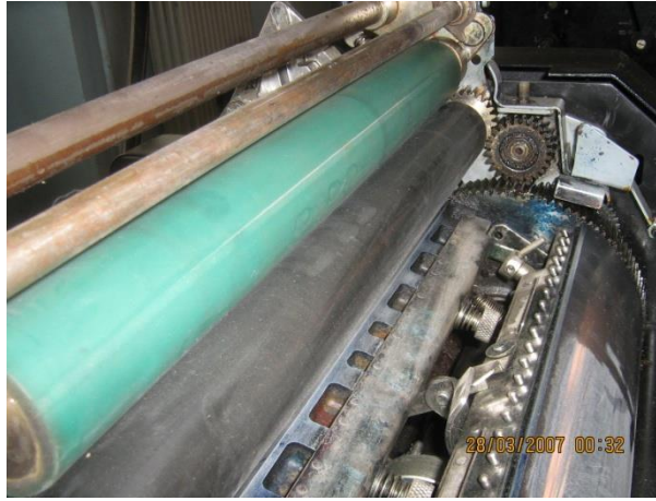
Resim 2.6: Temizlenmiş nemlendirme ünitesi
