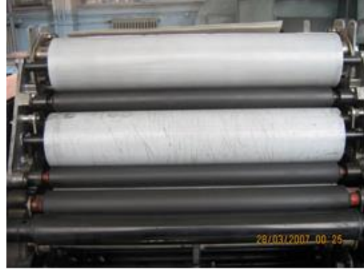
Resim 2.2: Temizlenmiş mürekkep ünitesi
