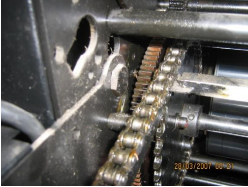
Resim 2.9: Zincirler ve dişliler için grease yağı
