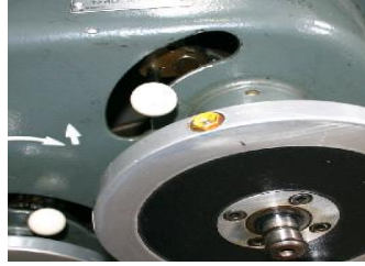
Resim 1.7: Asansörün hareket etmesi için kaldırma kolu kilidinin açılıp kapatılması gereklidir.
