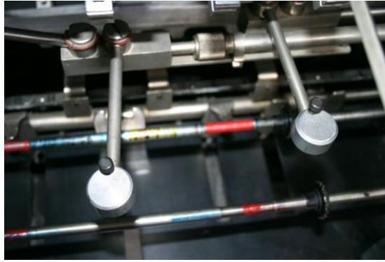
Resim 1.15: Çıkış asansöründeki üfleyiciler kâğıdın düzgün istiflenmesini sağlar.
