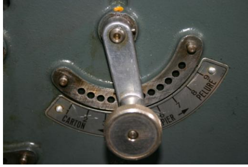
Resim 1.9: Asansör otomatik kaldırma demiri ayarı kâğıt gramajına göre ayarlanır.
