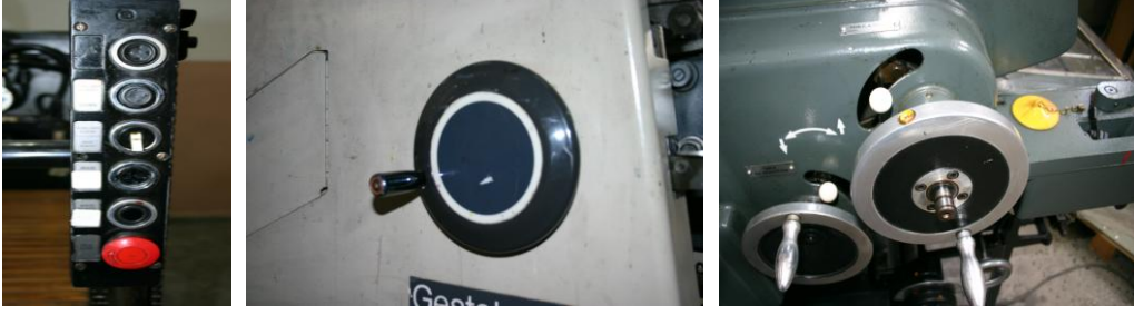
Resim 1.6: Aparatlı makinelerde asansör iniş kalkışları düğmelerle küçük makinelerin çevirmeli kolla sağlanan asansör kaldırma kolları
