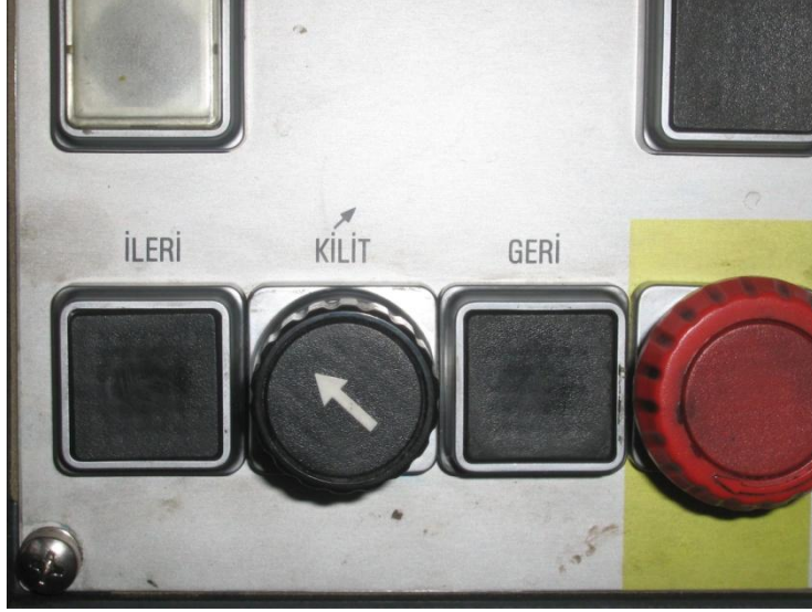
Resim 1.9: Kalıbın makineye otomatik takılmasını sağlayan butonlar
