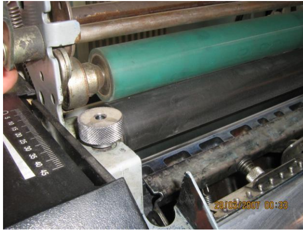
Resim 2.4: Su haznesi sökülmüş ünite
