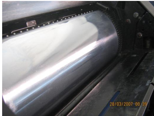
Resim 2. 6: Temizlenmiş kalıp kazanı
