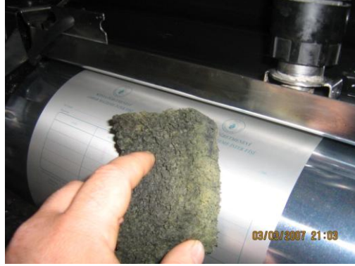
Resim 2.7: Kalıp temizleme işlemi
