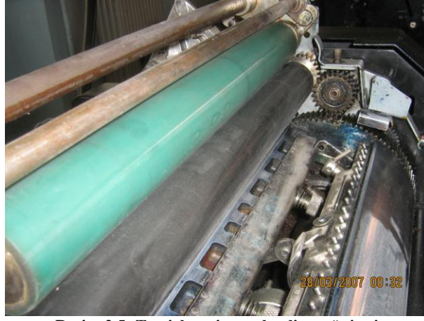
Resim 2.5: Temizlenmiş nemlendirme ünitesi
