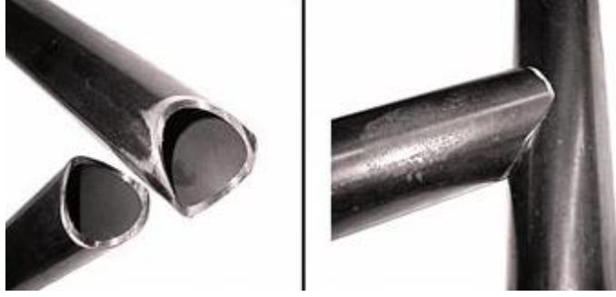
Resim 4.3: 45° kol alma için alıştırılmış parçalar
