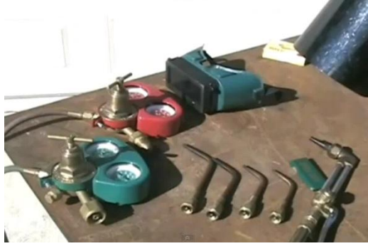
Resim 3.4: Oksi asetilen kaynak postası elemanları
