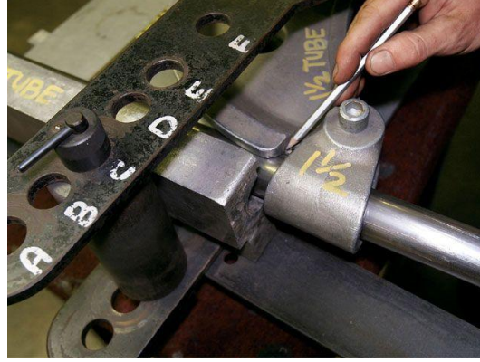
Resim 7.5: Borunun bükme esnasında markalanması
