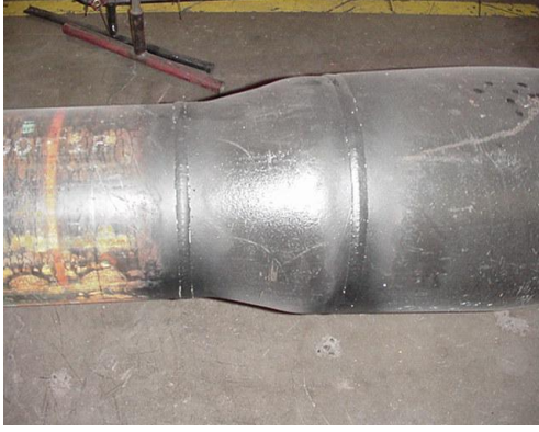
Resim 3.5: Kaynaklı çap daraltma parçası Resim 3.6: Aynı eksenli ve ayrı eksenli daraltma parçası
