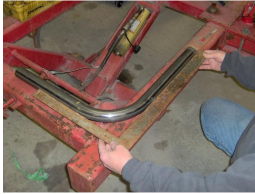
Resim 7.6: Gönye ile büküm yerinin kontrolü
