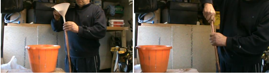
Resim 7.3: Borunun kumla doldurulması Resim 7.4: Boru ucunun tıpayla kapatılması
