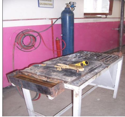
Resim 1.2: Oksi gaz kaynak elemanları
