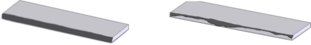
Şekil 1.4: Oksi-gazda kenet kaynağı (telsiz birleştirme) yapılmış iş parçasının kırılmış görüntüsü
