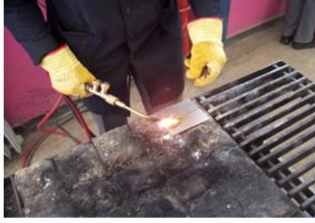
Resim 2.3: Sola doğru kaynak işlemi
