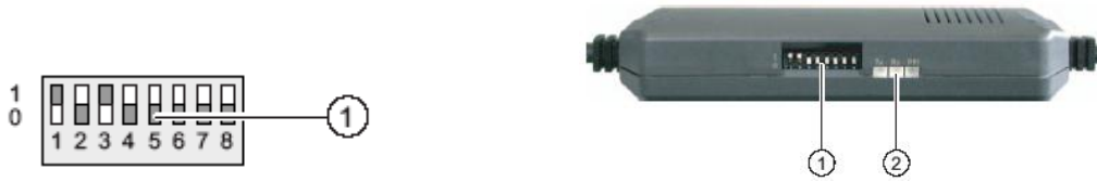
Şekil 1.13: Operatör paneli ile PC arasındaki bağlantı ayarları
