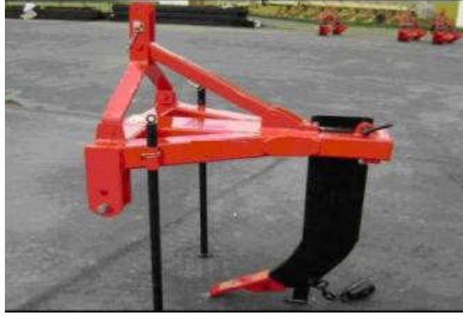
Resim 2.19: Düsey toprak işlemede de kullanılan dip kazan
