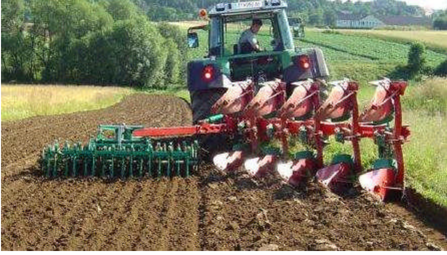
Resim 2.8: Döner kulaklı pullukla toprak işleme ve kesek kırma
