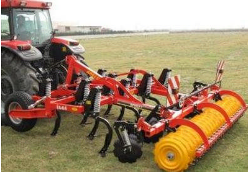
Resim 2.9: Yaylı kltivatr, diskli trmk ve merdane kombinasyonu
