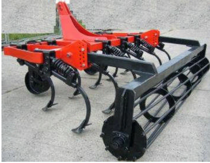
Resim 2.14: Koruyucu toprak işlemede kullanılan kazayağı ve döner tırmık
