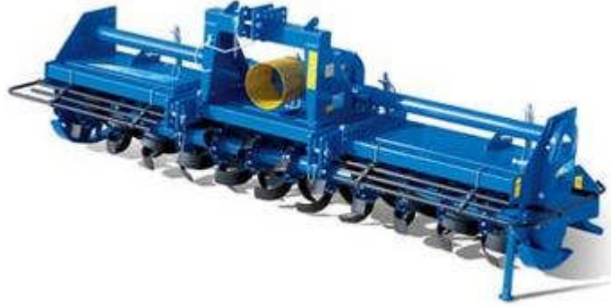
Resim 2.16: Minimum toprak işlemede de kullanılan toprak frezesi
