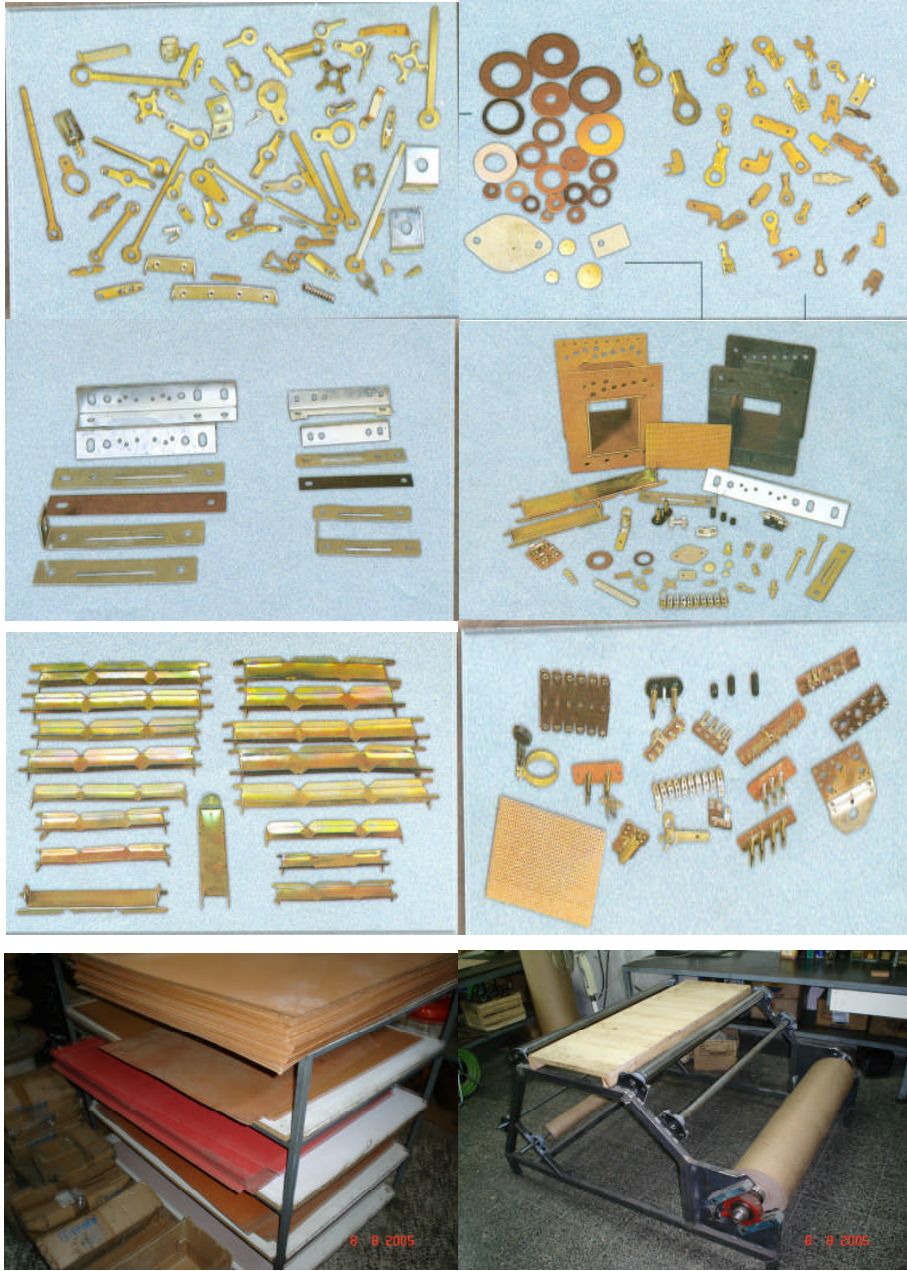
Resim 3. 7: Oto trafosu imalatında kullanılan çeşitli malzemeler
