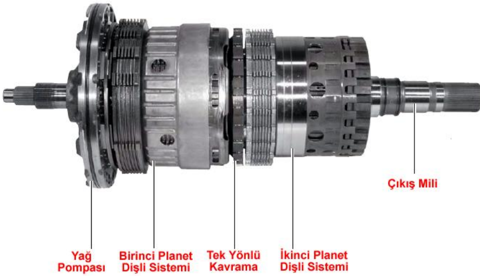
Resim 5.5: Tiptronik vites kutusu planet dişli sistemleri
