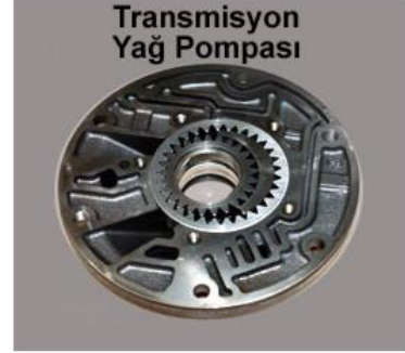
Resim 2.6: Yağ pompası ve transmisyon üzerindeki yeri
