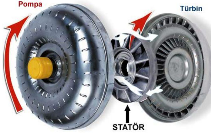
Resim 1.3: Pompa ve türbin arasında bulunan statör
