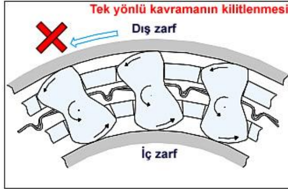
Şekil 3.11: Tek yönlü kavramanın geri yönde kilitlemesi
