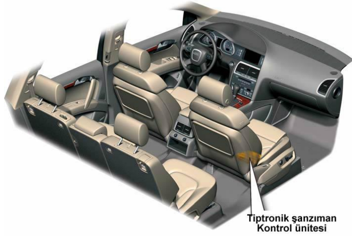
Resim 5.7: Tiptronik vites kutusu elektronik kontrol ünitesinin yeri
